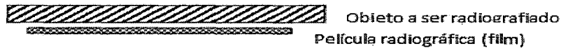
Figura 3.8. Exposición de pared simple– Simple imagen (En planchas) Fuente: Elaboración propia propia
