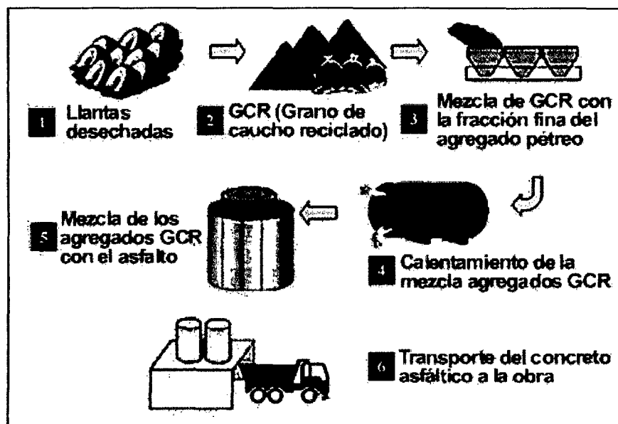
Figura 3.4: Esquema de fabricación de la mezcla asfáltica con caucho por vía seca.
