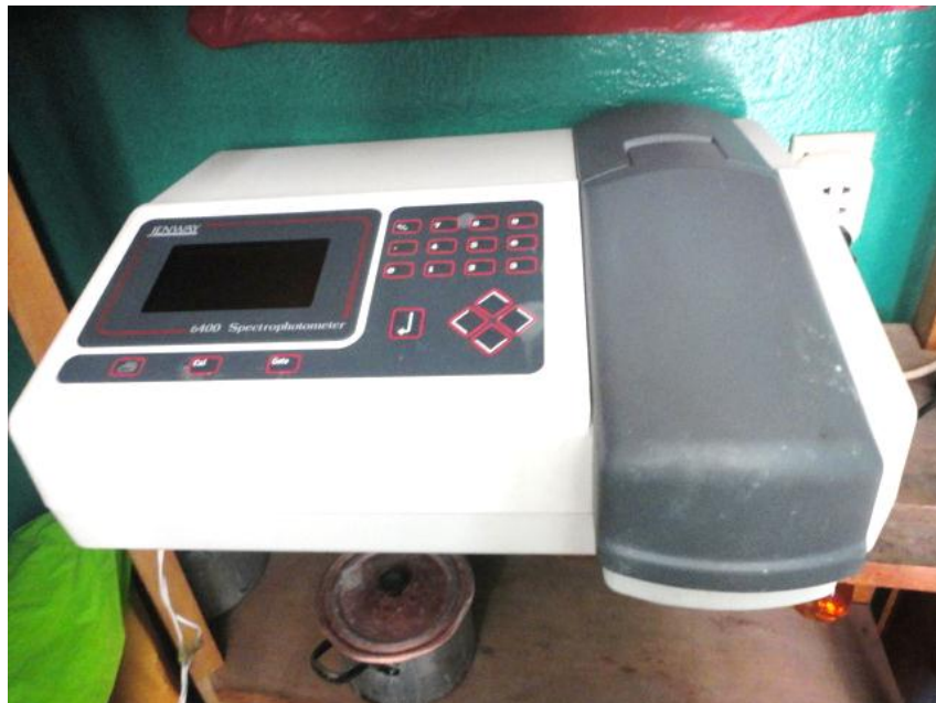
Figura 13. Espectrofotómetro utilizado para la lectura de la concentración de alcohol étílico en el laboratorio de investigación del Servicio de Dosaje Étílico en la REGSAL-PNP –SANIDAD.
