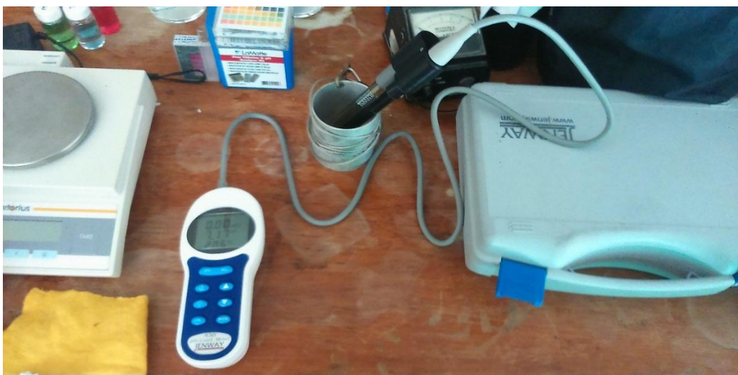
c. Medidor de ph, solidos totales disueltos y conductividad
