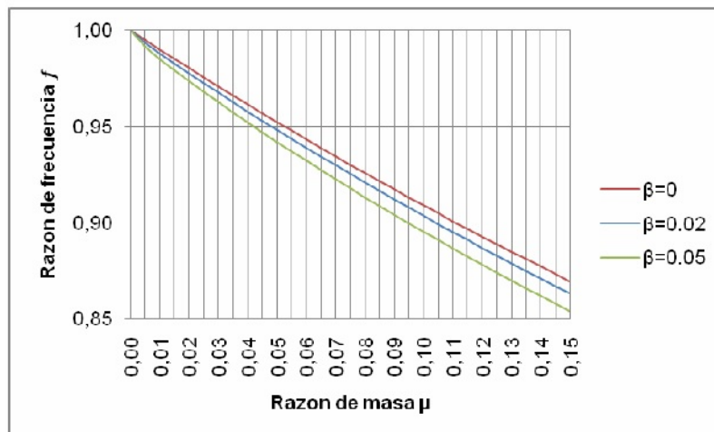
Figura 2.17: Razones óptimas de frecuencia de AMS, para distintas razones de masa Fuente [18].
