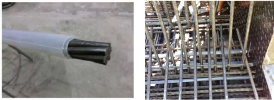
Figura 2.6: Revestimiento con mangueras para decementar el torón Fuente: [1].
