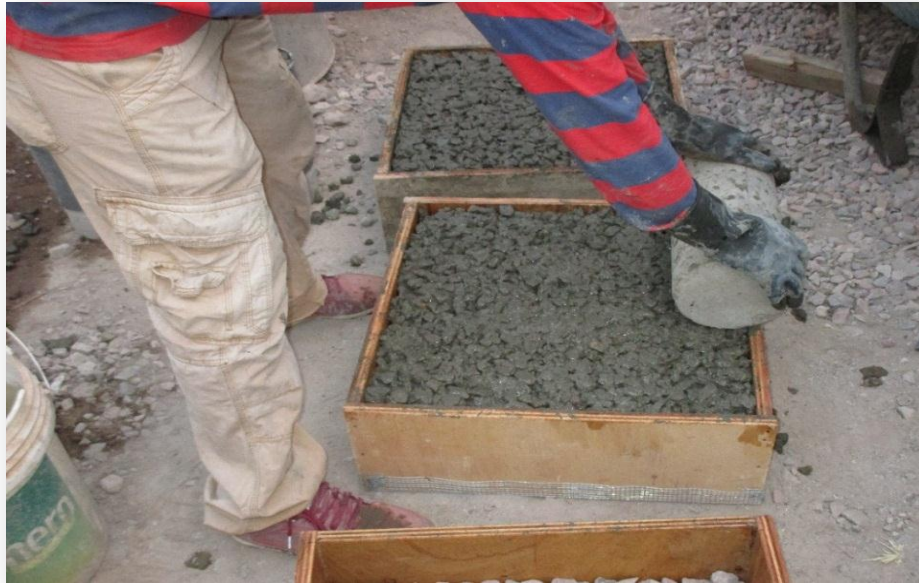
Figura 4. 15 Finalización de preparación de muestra para el concreto poroso.
