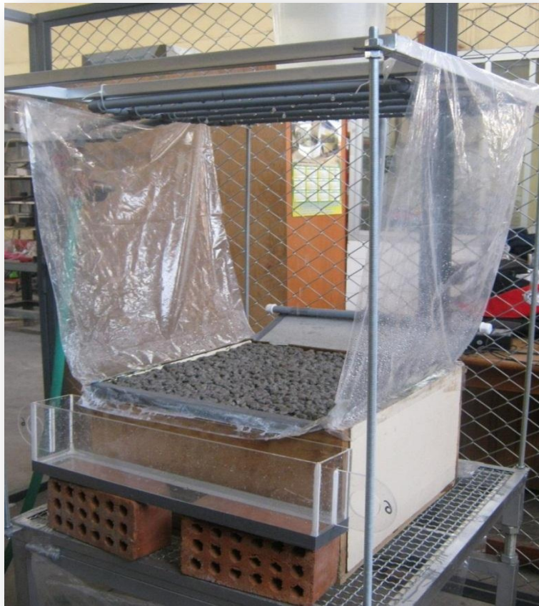
Figura 4. 12 Equipo de cántabro fijo empleado para el desarrollo de ensayo de colmatación de finos en la investigación.
