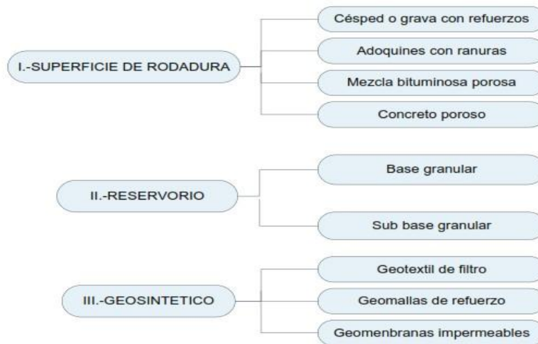
Figura 2. 5 Descripción de los contenidos de las diferentes capas que conforman el pavimento permeable
