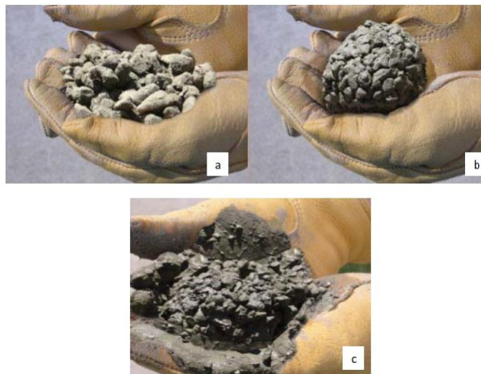
Figura 3. 2 Muestras de concreto permeable con diferentes cantidades de agua: (a) con poca agua, (b) adecuada cantidad de agua, (c) con demasiada agua.
