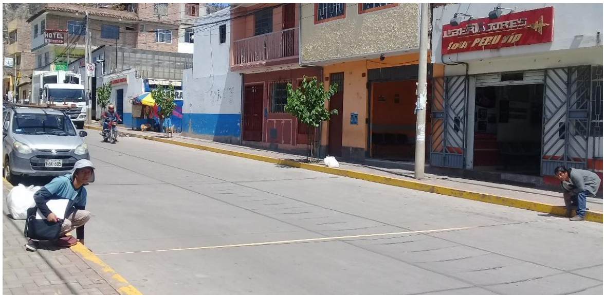
Figura 36: Toma de medidas de ancho de calzada en Jr. Manco Cápac, entre Jr. 9 de Diciembre y Jr. Garcilazo de la Vega. Fuente: Elaboración propia.
