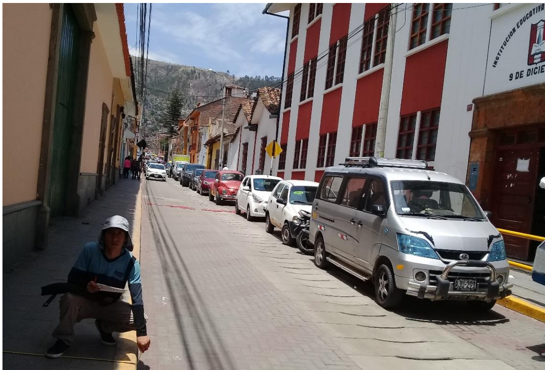
Figura 40: Toma de medidas de ancho de calzada y vereda en Jr. 9 de Diciembre entre Jr. 3 Máscaras y Jr. Asamblea. Fuente: Elaboración propia.
