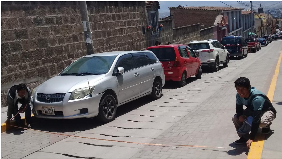
Figura 37: Toma de medidas de ancho de calzada en Jr. Lima, entre Jr. Libertad y Jr. Grau. Fuente: Elaboración propia.
