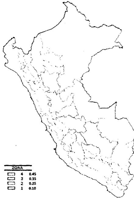
Figura 3.8: Distribución de zonas sísmicas. Fuente: RNE-E030
