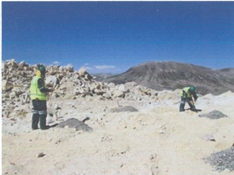
Figura 34: Primado de la malla de perforación. Fuente: (foto tomado en Mina Breapampa.
