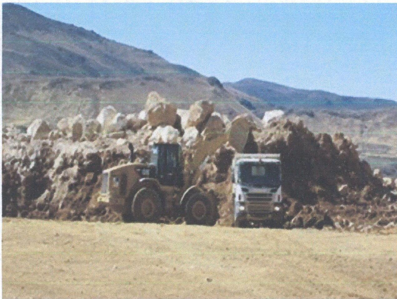
Figura 38: Carguío de mineral con Cargador Frontal CAT 966H.. Fuente: (foto tomado en Mina Breapampa.
