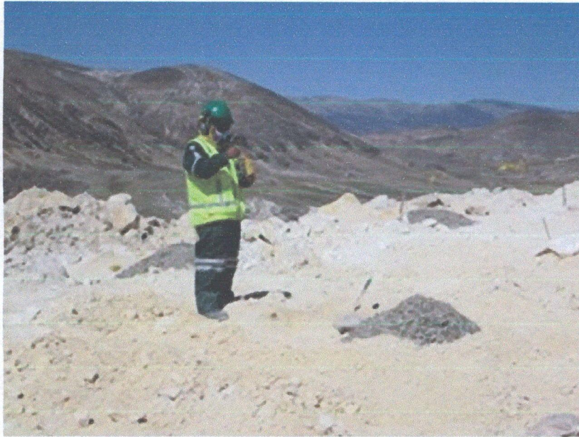
Figura 35: Amarre de la malla de perforación. Fuente: (foto tomado en Mina Breapampa.
