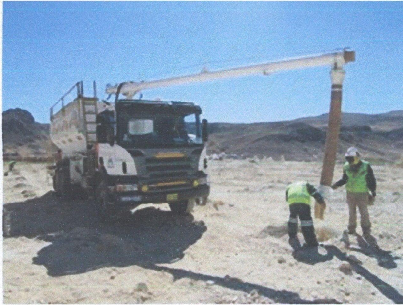
Figura 33: Carguío de un taladro de la malla de voladura. Fuente: foto tomado en Mina Breapampa.
