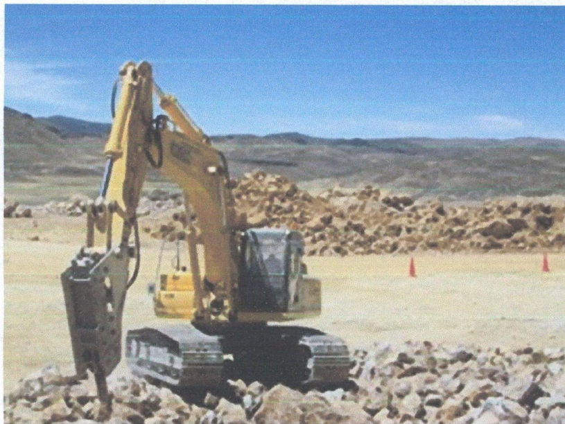
Figura 40: Picotión fragmentando bancos de gran tamaño Fuente: (foto tomado en Mina Breapampa.
