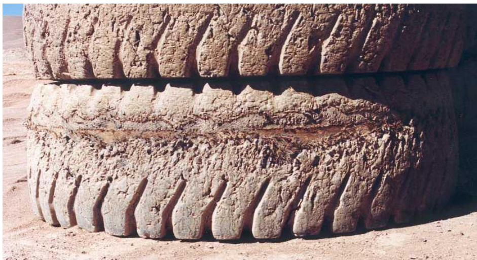
Gráfico Nº 25. Desgaste de Banda de Rodamiento
