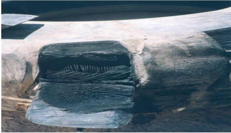
Gráfico N° 16. Separación por Calor de un Neumático
