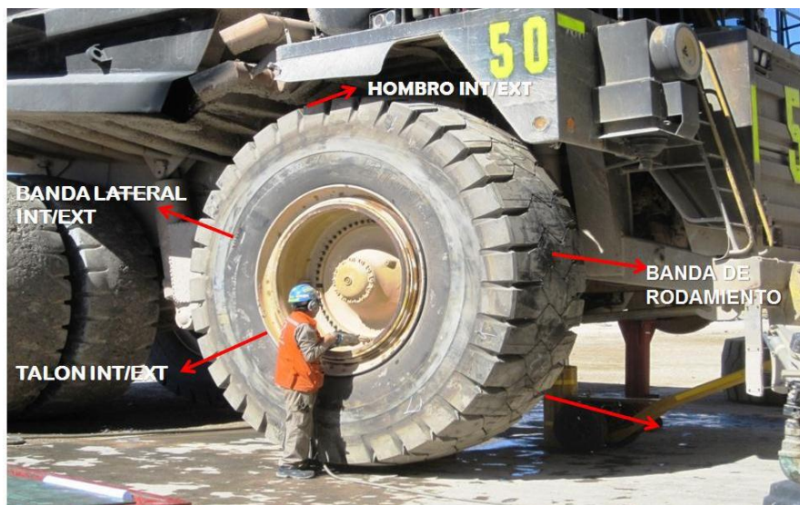
Gráfico N° 10. Secciones de los neumáticos
