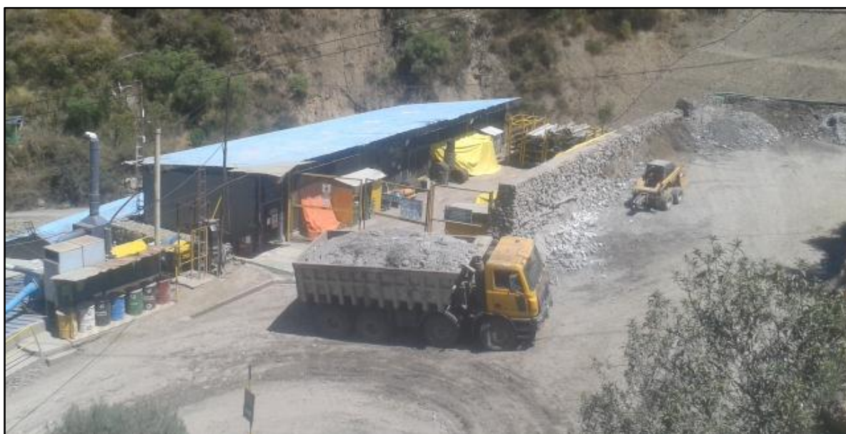
FIG. 17 - "volquete IVECO ASTRA 8x6, en operación de transporte de mineral"
