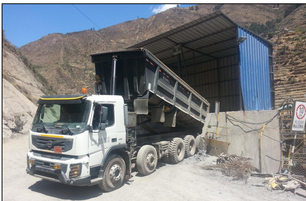
FIG. 16 - "volquete Volvo FMX 10x4, en operación de descarga de mineral"
