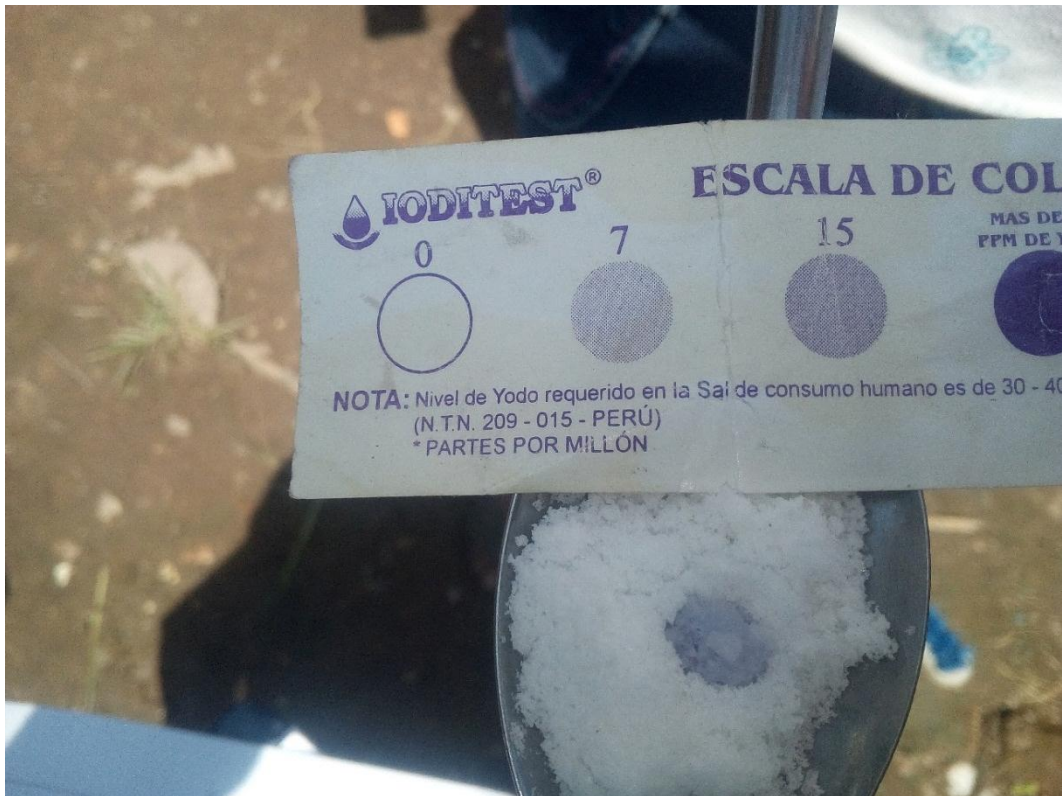
Foto N° 10. Resultados de yodites que arroja una baja concentración de yodo.
