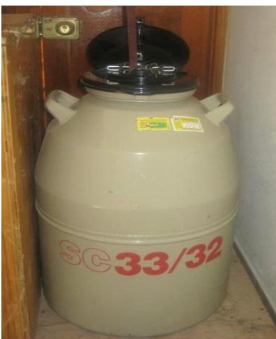
Tanque de N 2
