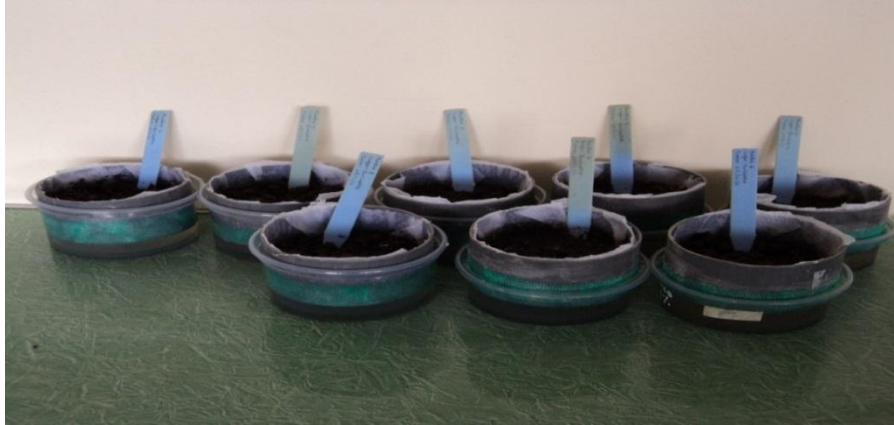
Fot. 2.6. Extracción de nematodos machos del genero Meloidogyne por método de la bandeja.
