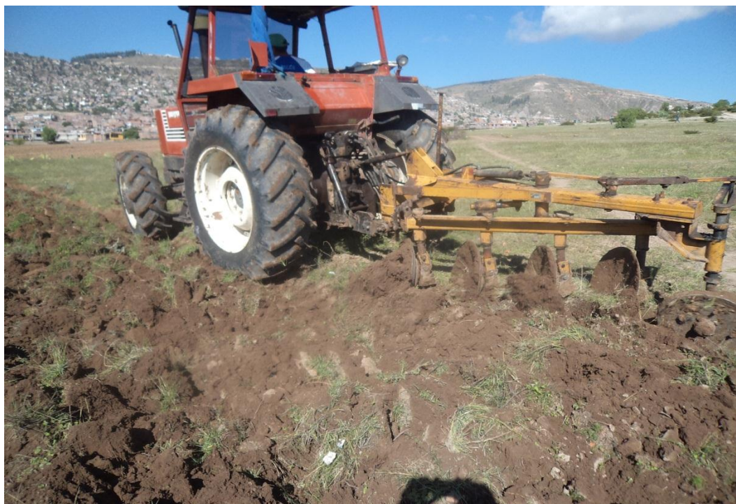
Foto 2 Labranza convencional arado de cuatro discos
