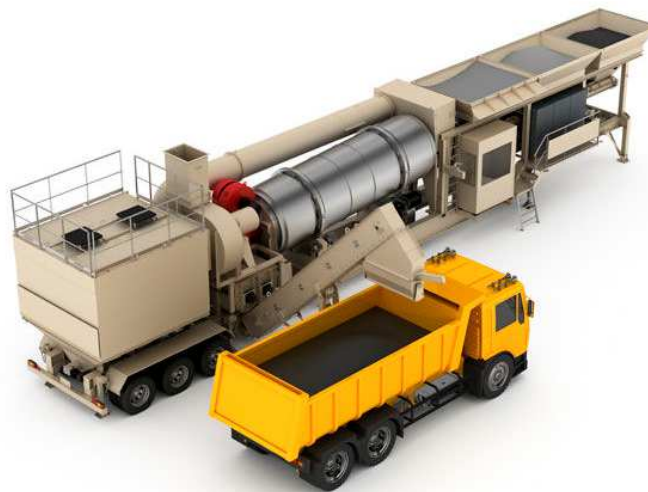
Figura 7 Planta de asfalto
