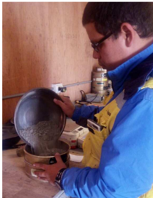
Figura 18 Tamizado de los agregados separados de la mezcla
