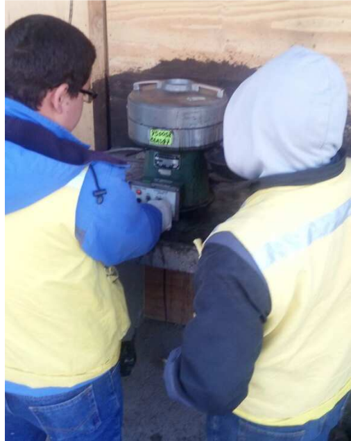
Figura 15 Encendido de la centrífuga
