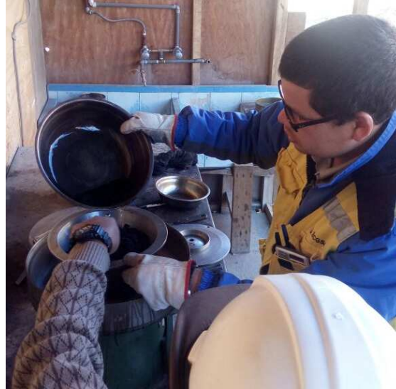
Figura 13 Colocación de la mezcla y el solvente
