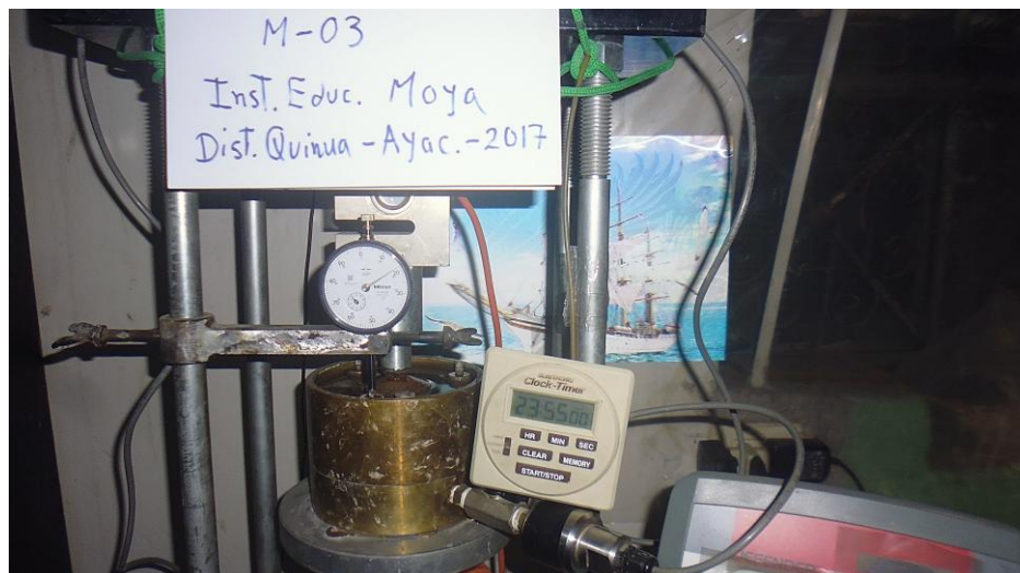
Figura 3.20: Ensayo de consolidación
