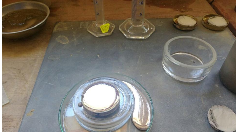
Figura 3.13: Volumen de Mercurio desplazado por la muestra
