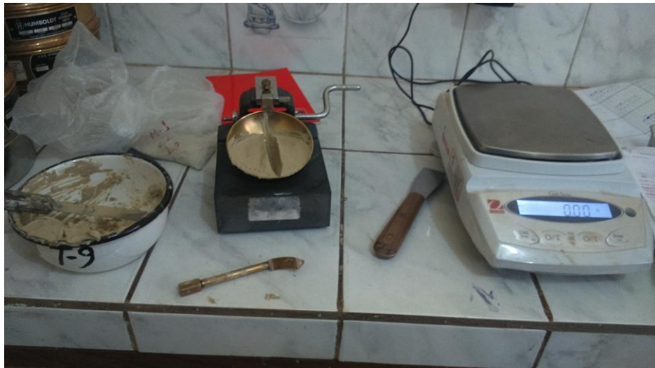
Figura 3.8: Ensayo para límite líquido en copa de Casagrande
