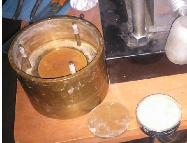
Figura 3.5: Cámara de consolidación
