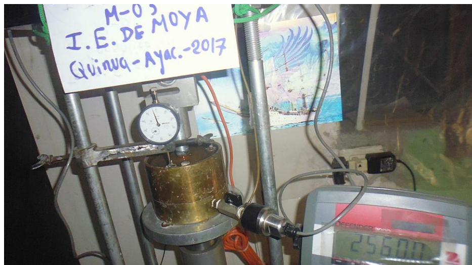
Figura 3.21: Ensayo de consolidación para cada ciclo de carga
