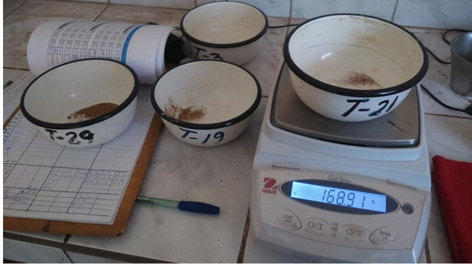
Figura 3.16: Pesado de muestras lavada y retenidas por malla # 200
