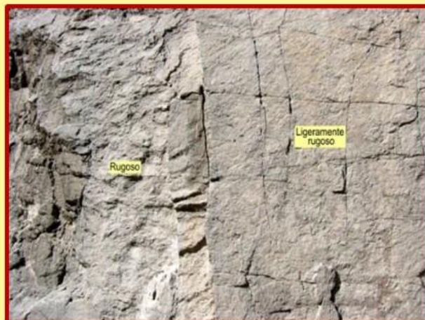
IMAGEN 4.18 Grado de aspereza de discontinuidades.
