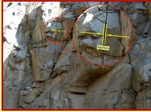
IMAGEN 4.17 Apertura de una discontinuidad.
