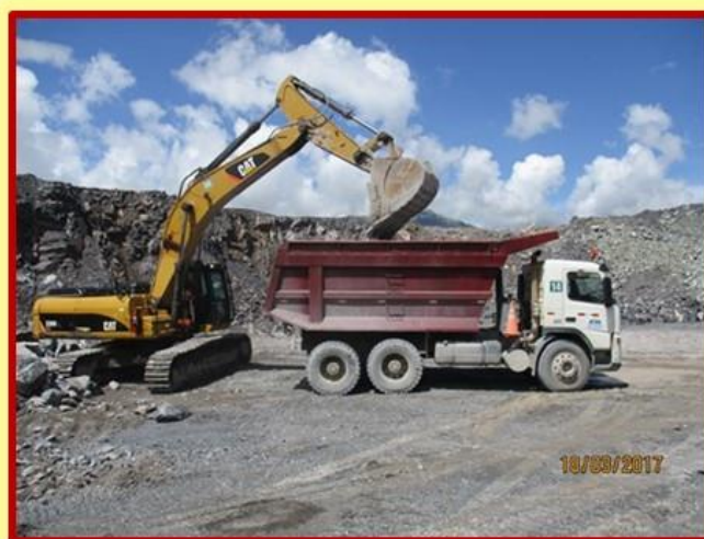
IMAGEN N° 3.5: Carguío de caliza tipo cal del nivel 690 CERRO ESTE
