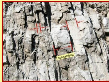
IMAGEN 4.15 Espaciado de una discontinuidad.
