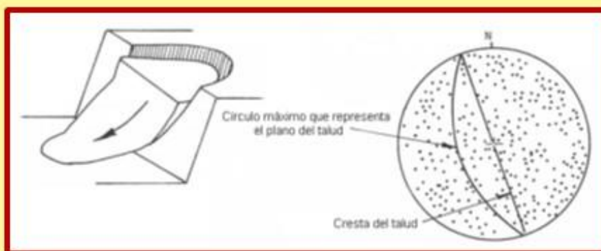
IMAGEN N° 4.26: Proyección estereográfica de rotura rotacional.
