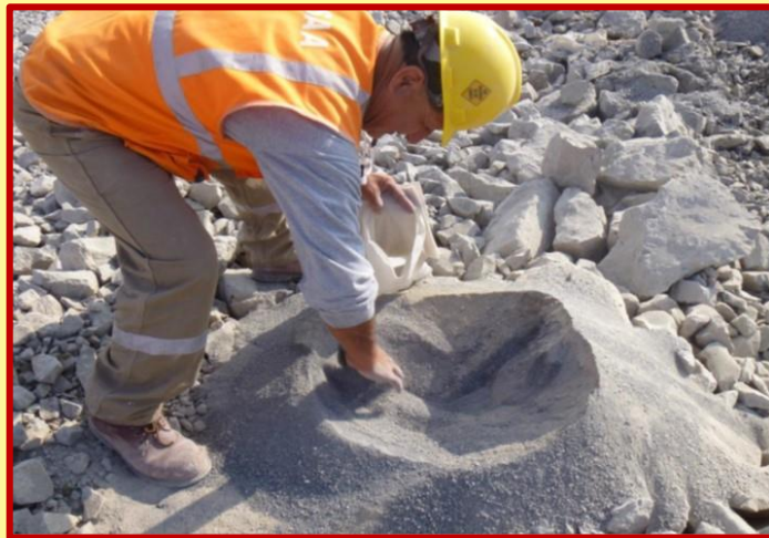
IMAGEN N° 3.7: Toma de muestra de taladro por muestrero.
