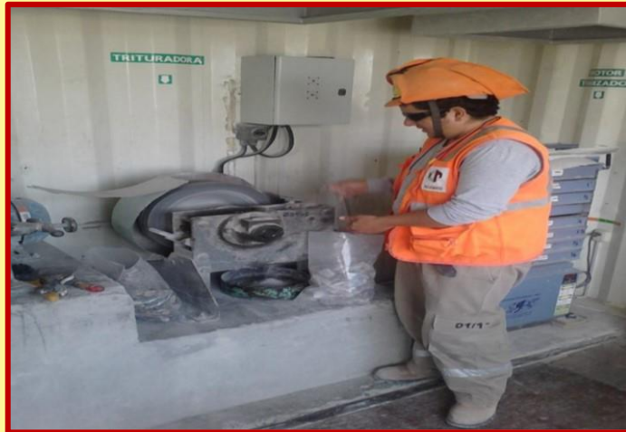
IMAGEN N° 3.8: Trituración de material del taladro.
