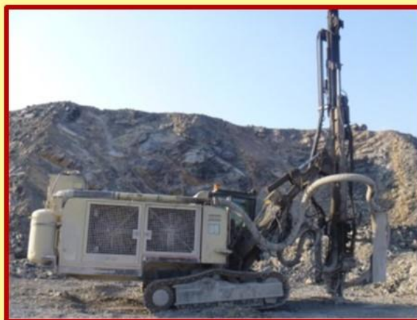
IMAGEN N°3.1: Perforadora ATLAS COPCO
