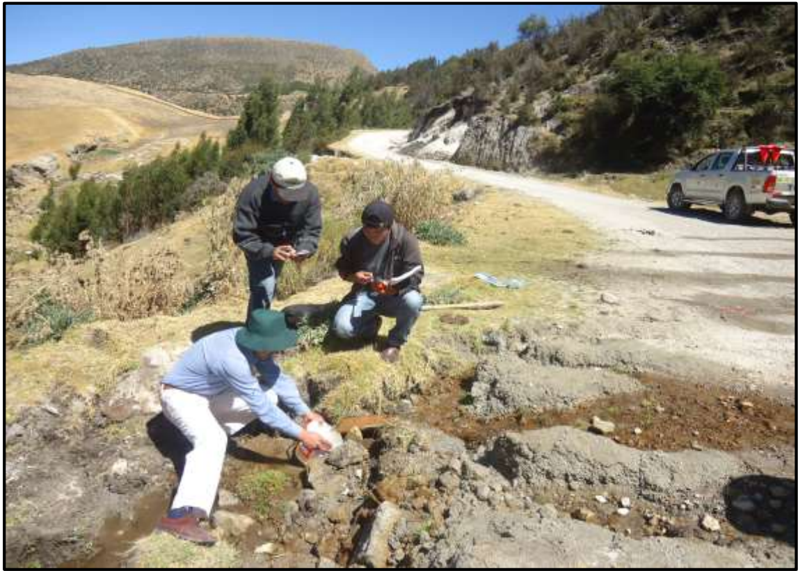
Imagen 2.1. Aforamiento de manantiales y toma de datos con GPS
