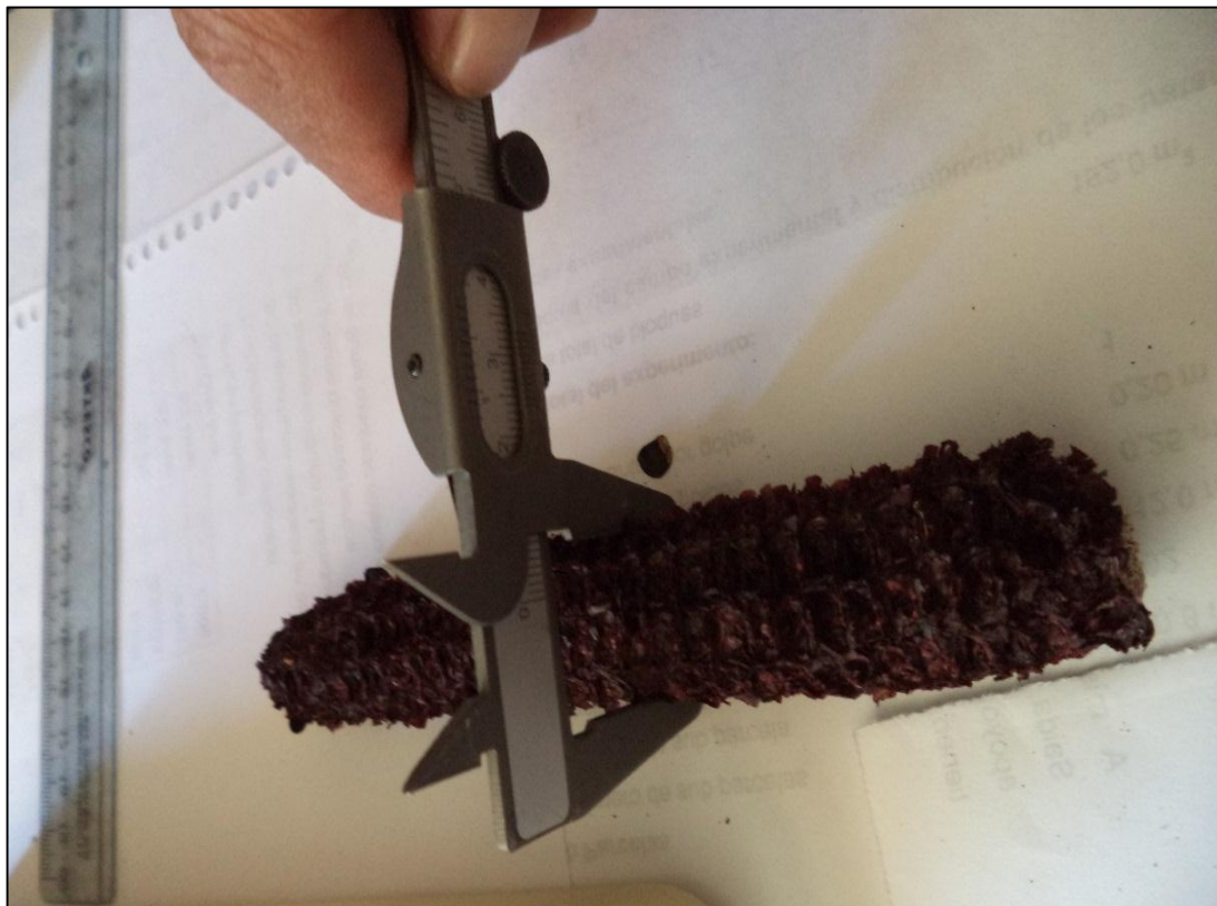
Fotografía 19: Medida del diámetro de la tusa de una mazorca con un vernier.
