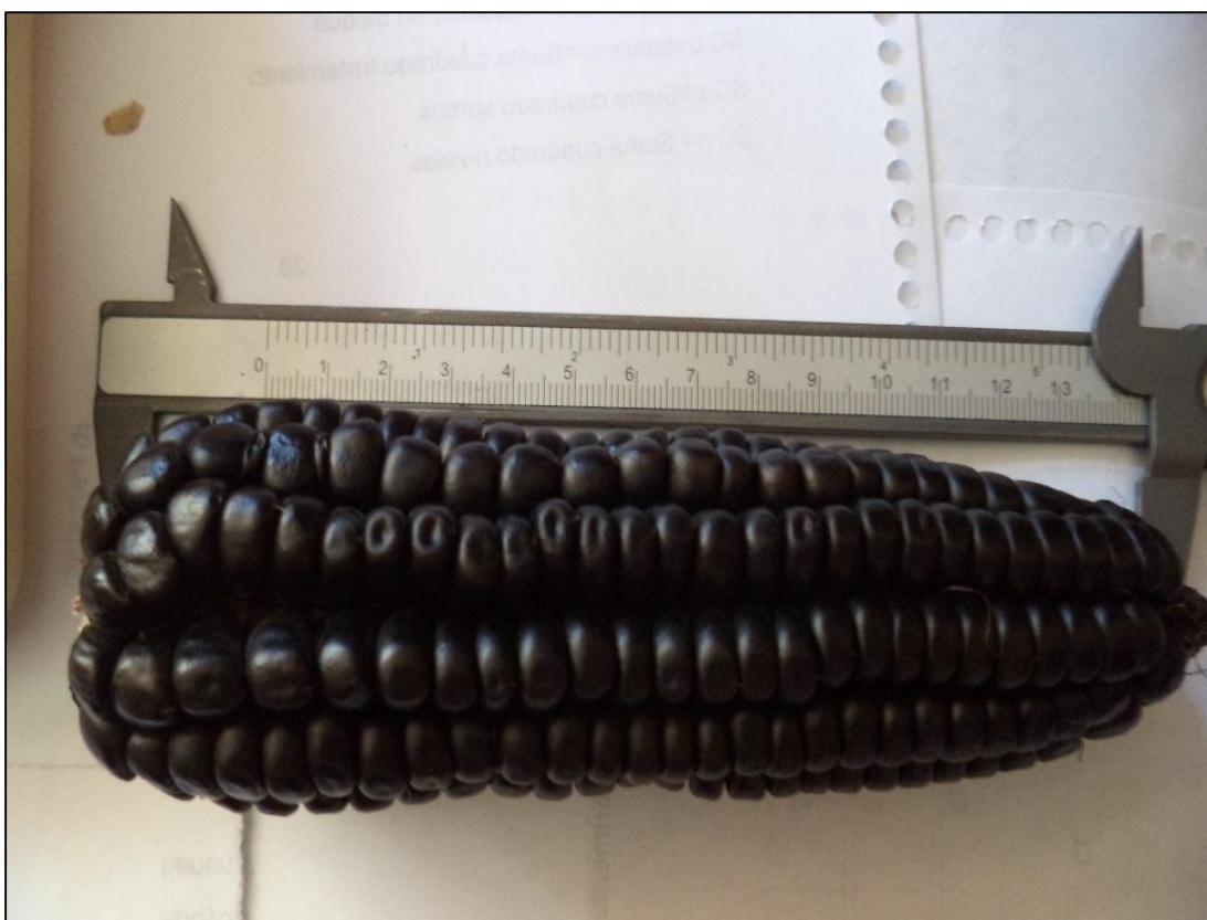
Fotografía 14: Medida de la longitud de mazorca con un vernier.
