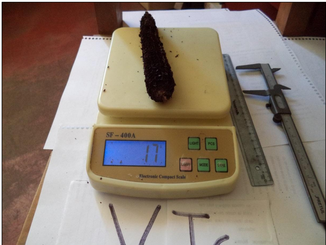
Fotografía 18: Pesada de la tusa de una mazorca en una balanza gramera.
