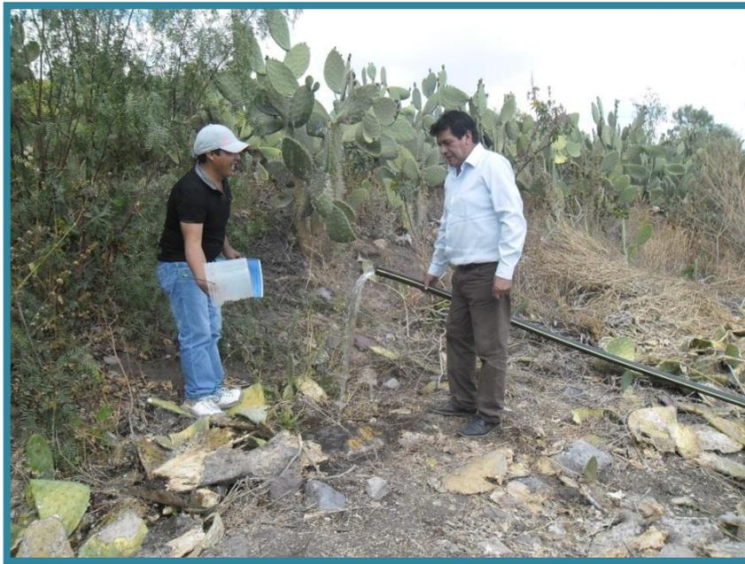
Figura III.50. Entrega de agua a 19 metros de altura respecto de la bomba de ariete hidráulico.
