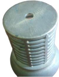
Figura III.13. Primera bancada manufacturada en la canastilla de broce. (e = 2mm)
