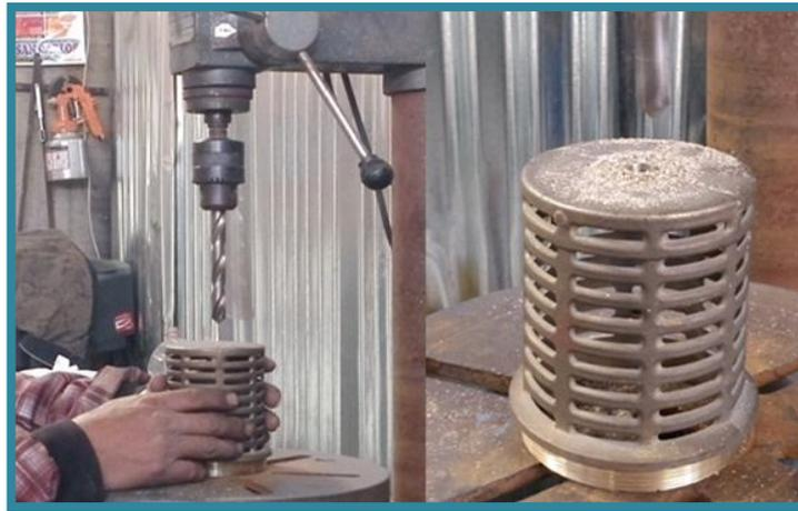
Figura III.24. Perforación en la canastilla de la válvula check de succión.
