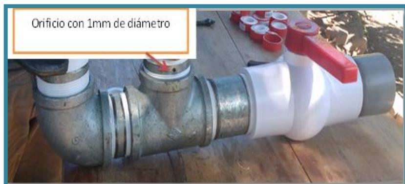
Figura III.23. Cuerpo de la bomba de ariete construida.
