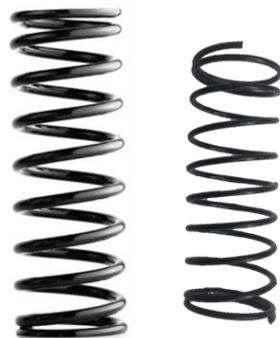
Figura III.12. Resorte principal y secundario de la válvula de impulsión.
