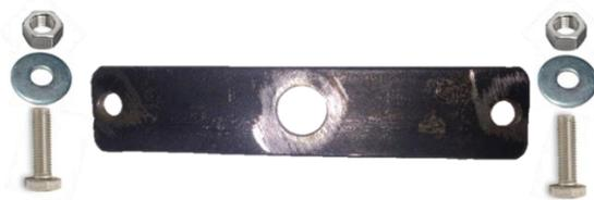
Figura III.14. Segunda bancada centradora del vástago (e = 2mm).
