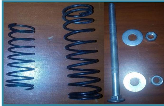
Figura III.26. Resorte y vástago de la válvula de impulsión.
