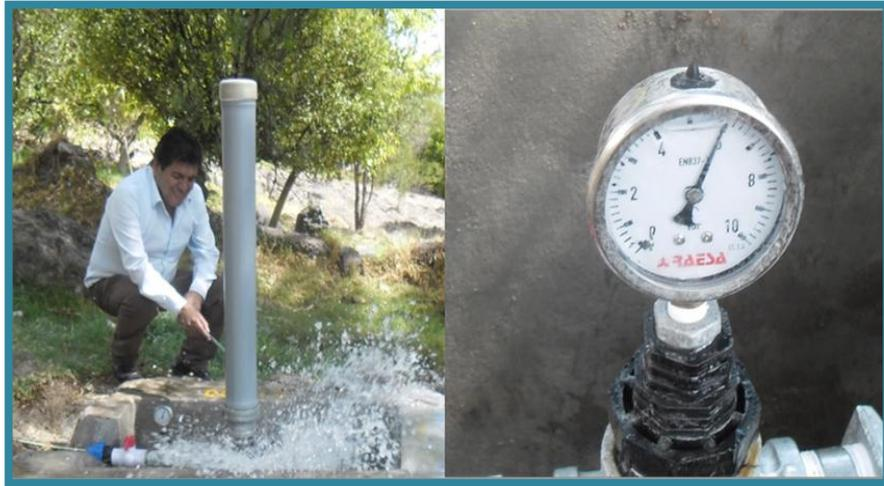
Figura III.49. Medición de la sobrepresión máxima causado por el golpe de ariete.
