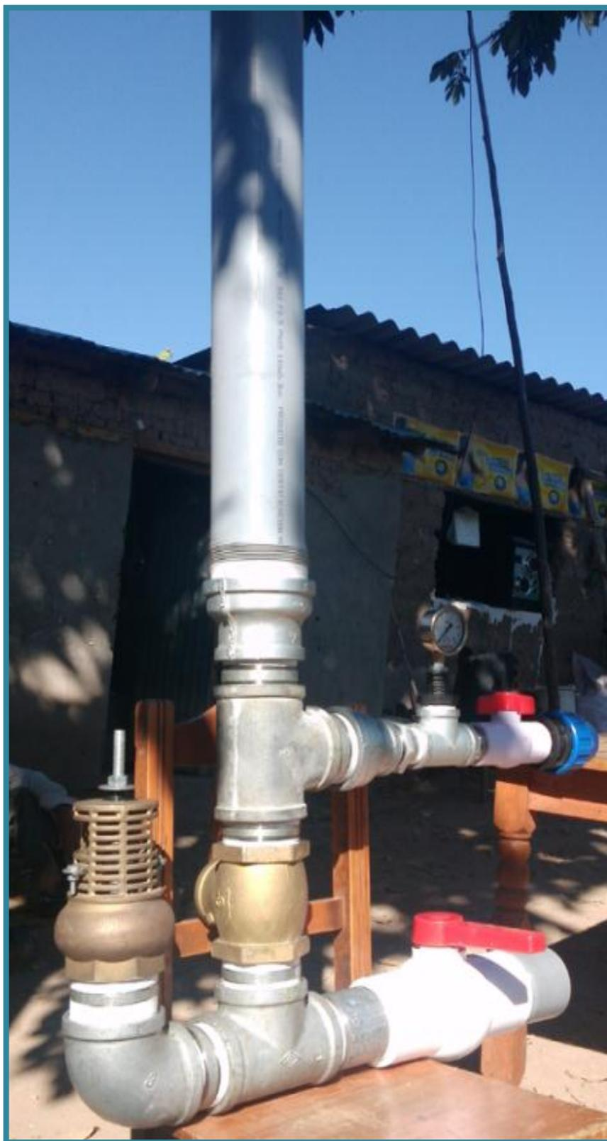
Figura III.32. Bomba de ariete hidráulico universal de 3 pulgadas.
