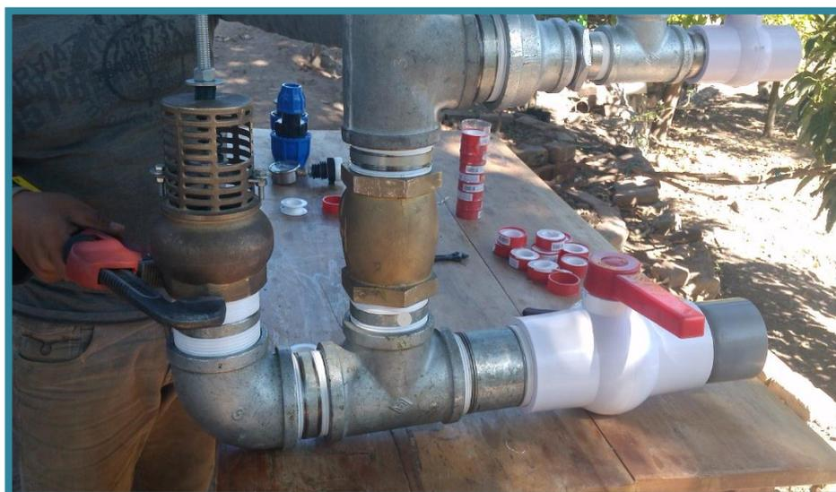
Figura III.31. Montaje de los componentes de la bomba de ariete.
