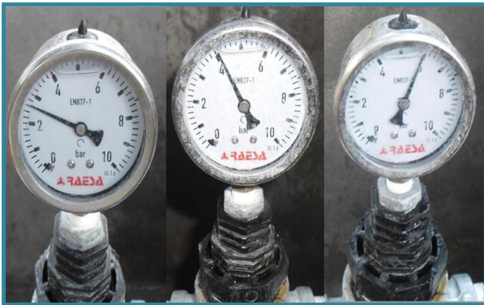
Figura III.51. Medición de la máxima sobrepresión por golpe de ariete
