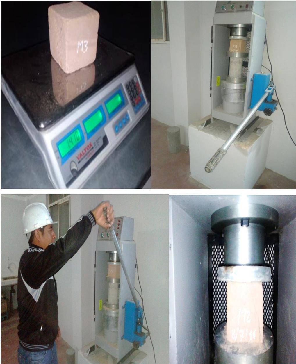
Fotografía N°15: Pesado y ruptura del bloque
