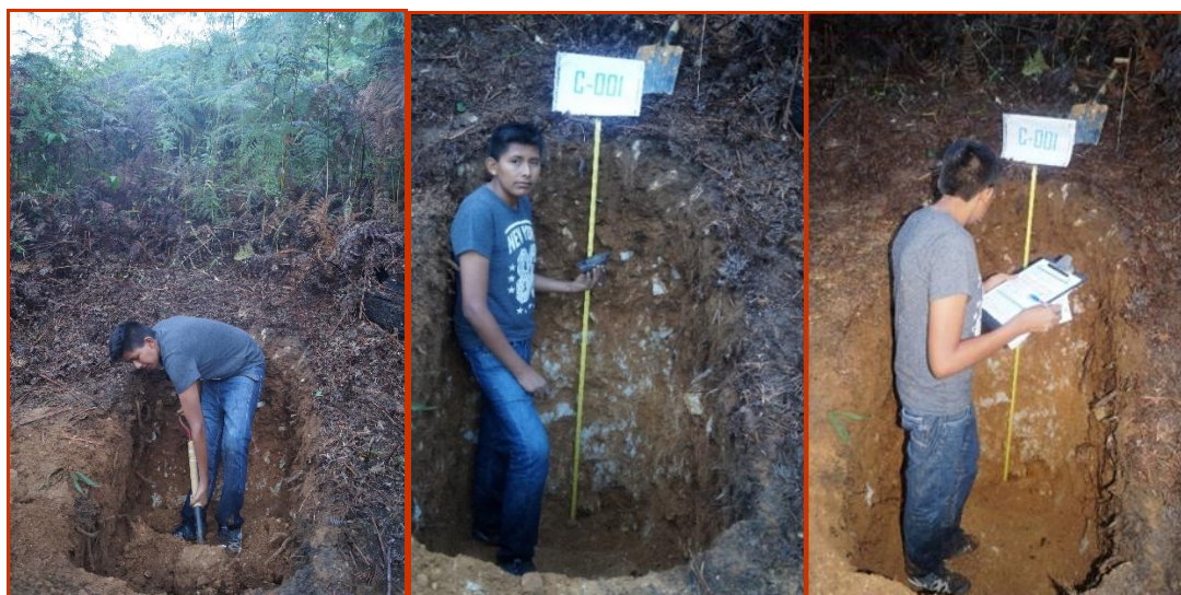
Fotografía A14. Apertura de calicata para análisis de suelo.
