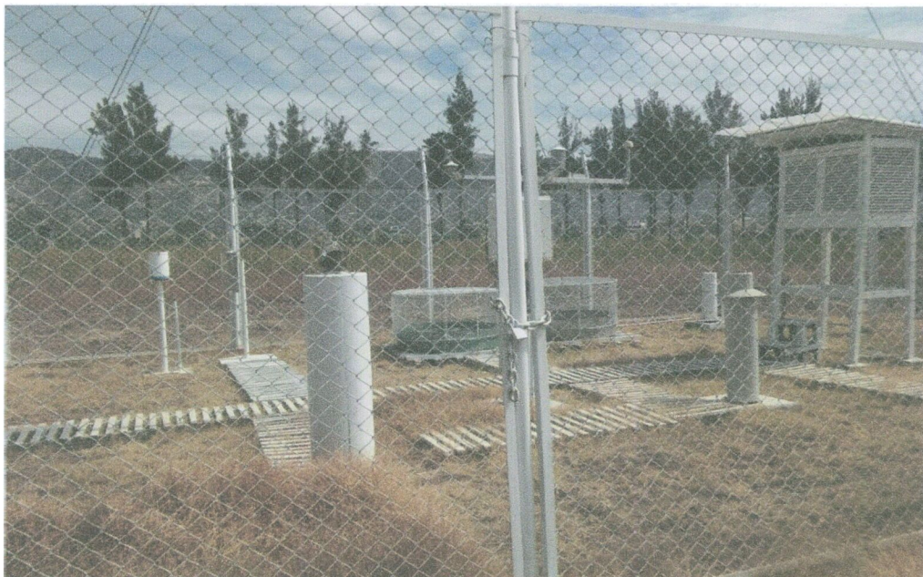
Foto N° 02: Vista de los equipos de medición de las principales variables meteorológicas, se pueden observar el pluviómetro, el tanque evaporímetro.
