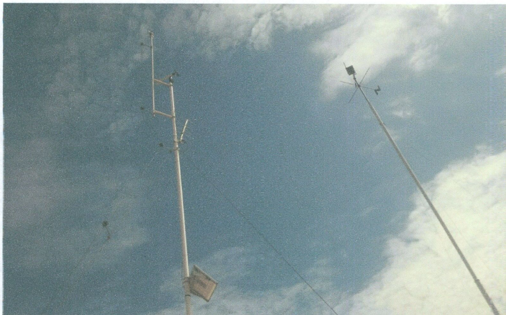
Foto N° 04: Vista del medidor de la velocidad del viento, este equipo es el encargado de medir la velocidad del viento en metros por segundo.
