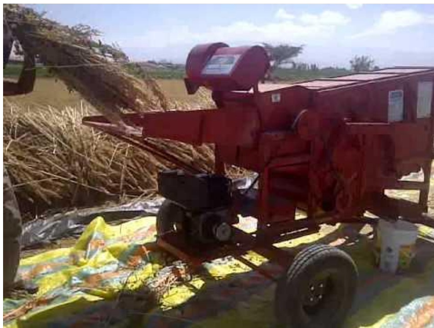
Fig. 44: Trilla mejorada con una maquina trilladora - venteadora de vencedora
