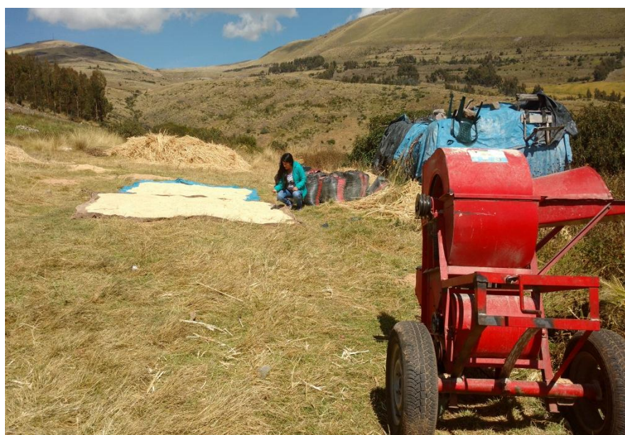
Fig 45: Trilla mejorada con una máquina trilladora - venteadora de fabricación china
