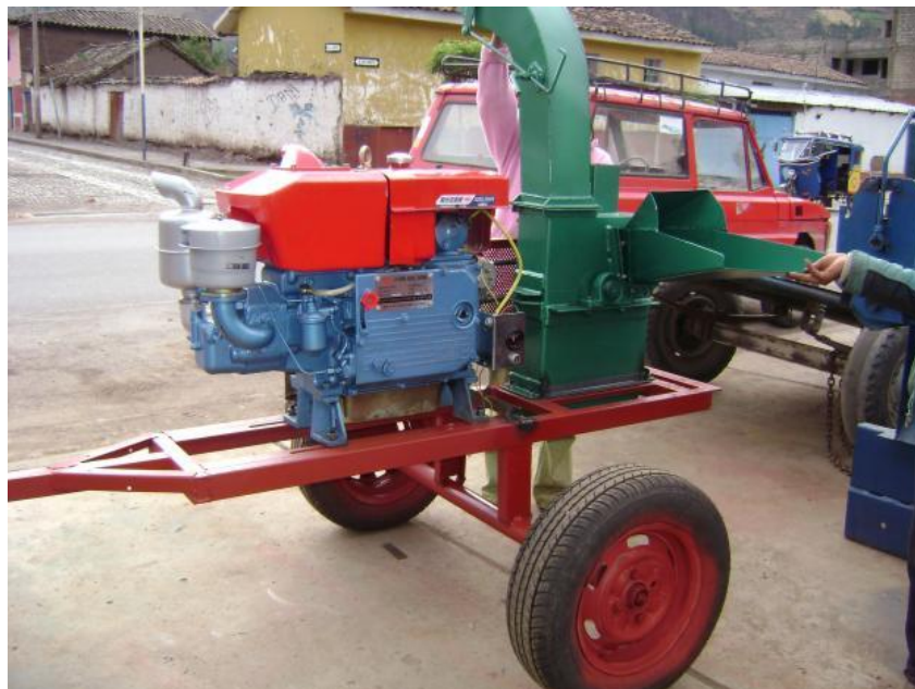
Fig. 13: Trilladora pequeña de 8 HP, marca INNOVA MAGRINI en cuzco
