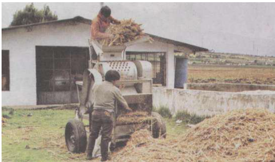
Fig. 43: Trilladora estacionaria de cereales, “PULLMAN” de fabricación americana, adaptada para la trilla de quinua
