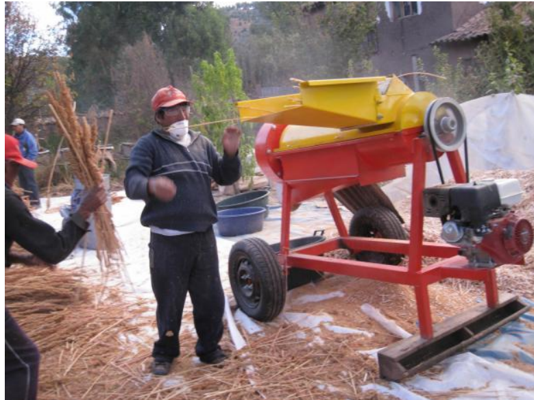
Fig. 14: Trilladora Herrandina modificada
