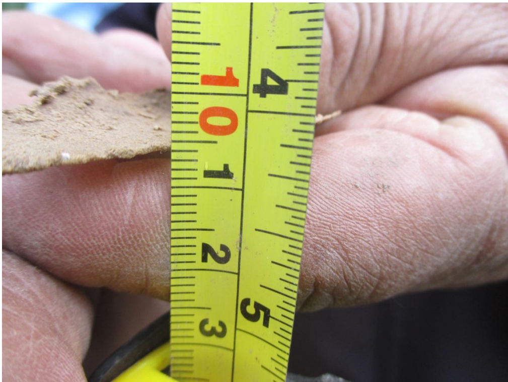
Foto N° 08. Formación de sarro de 5 mm después de dos años de funcionamiento.
