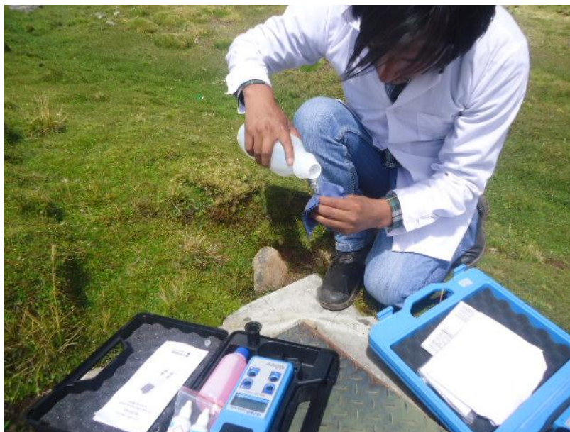
Figura 2. 5: Lectura de turbidez de agua en la captación
