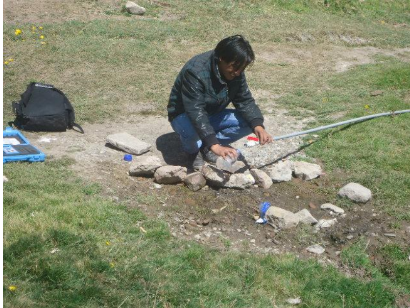
Figura 2. 8: Toma de muestra, lectura de turbidez y cloro residual en tubería rota improvisado como grifo.
