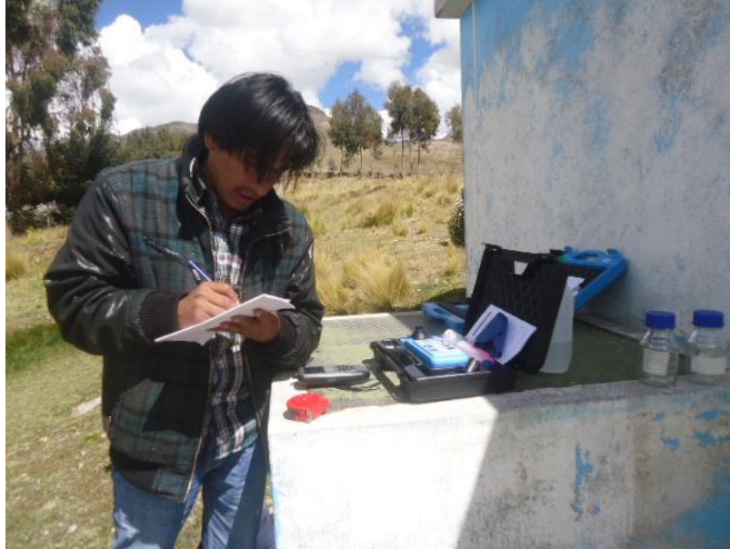
Figura 2. 6: Toma de muestra, lectura de turbidez y cloro residual en reservorio
