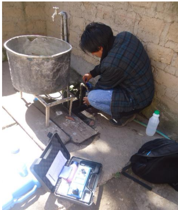
Figura 2. 7: Toma de muestra, lectura de turbidez y cloro residual en domicilio
