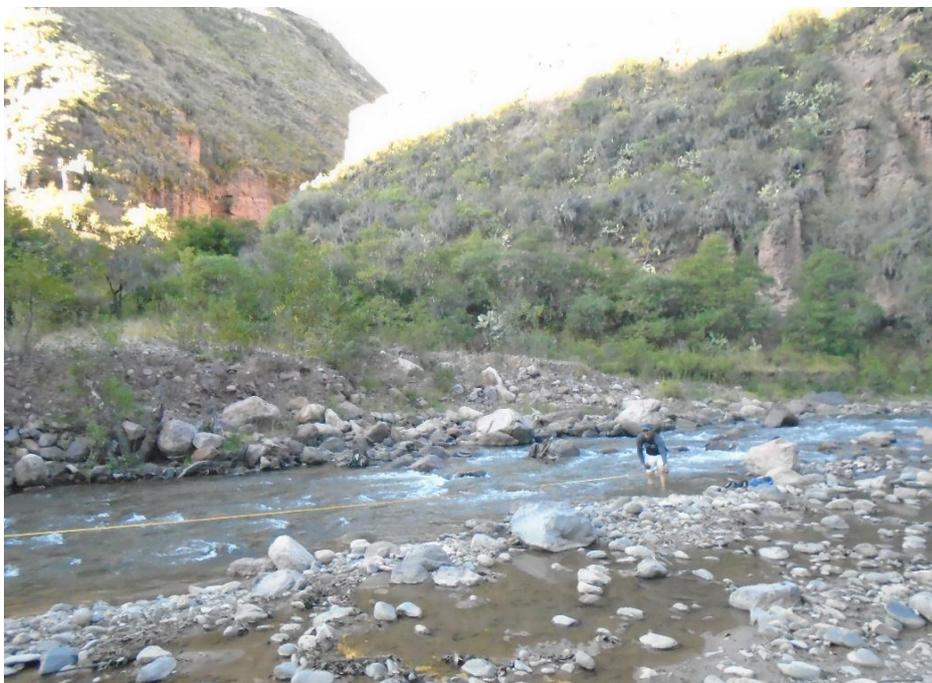
**Aforo del río Yucaes método del flotador**
