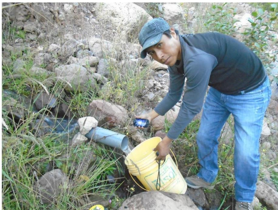
**Aforo de manantial con el método volumétrico**
