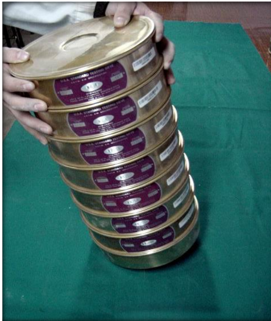
Figura A. 5: Se observa el tamizado del suelo para por las mallas n°10, 20, 40, 60,140 y 200.
