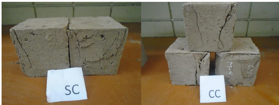
Figura A. 27: Final de las muestras SC y CC después de ser sometido al esfuerzo de compresión
