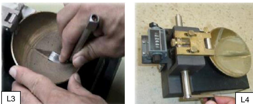
Figura A. 11: En L3 división del suelo en la taza de bronce con el ranurador, y en L4 prueba haciendo girar la manija de la copa de Casagrande
