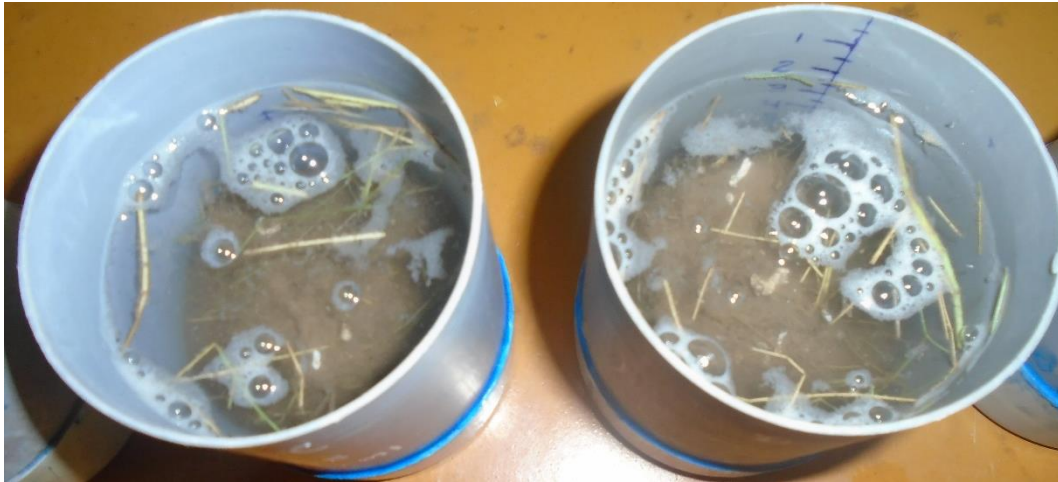
Figura 26. Desintegración total de los tratamientos estabilizados con solución de cactus y Stipa ichu
