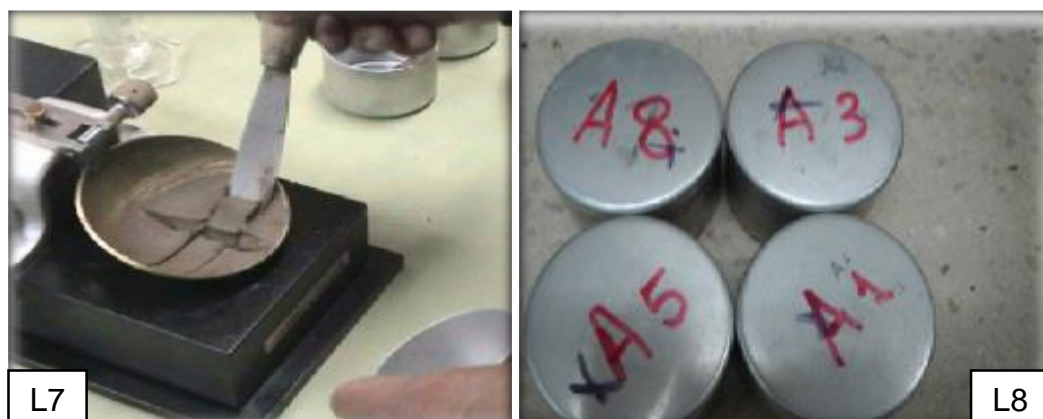
Figura A. 13: En L7 extracción del suelo del centro de la copa para luego tomar su peso húmedo, y L8 taras para poner las muestras
