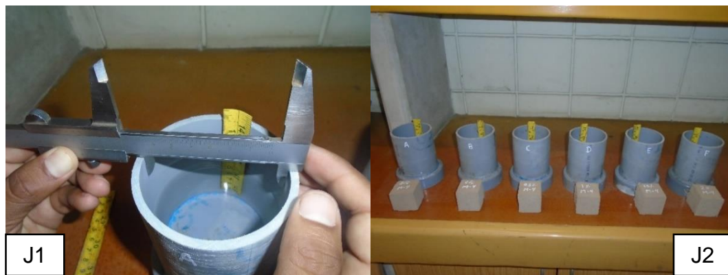
Figura A. 66: J1 se aprecia la calibración de la cubera con el vernier, y J2 las muestras a punto de realizarse las pruebas.
