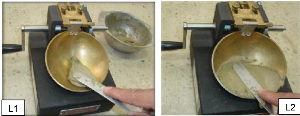
Figura A. 10: En L1 colocación de la muestra en la copa de Casagrande, y en L2 el nivelado del suelo con una espátula hasta una profundidad de 1 cm.
