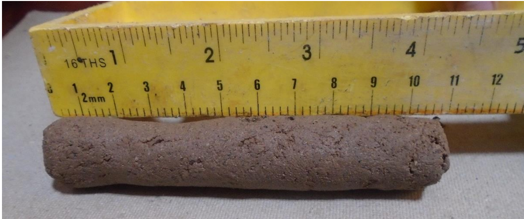
Figura A. 1: Muestra de la prueba de rodillo se encuentra entre los 11cm de longitud
