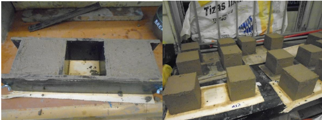
Figura 17. Proceso de elaboración de las muestras de adobes y el desmoldado.
