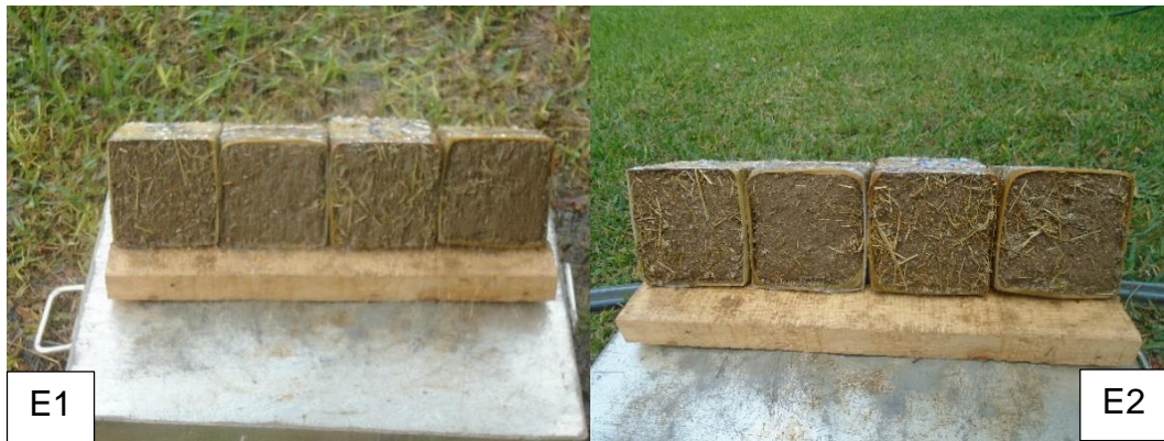
Figura 22. E1 durante el ensayo de erosión y E2 después del ensayo de erosión
