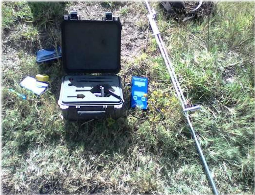
Figura 06: Instalación del equipo correntometro
