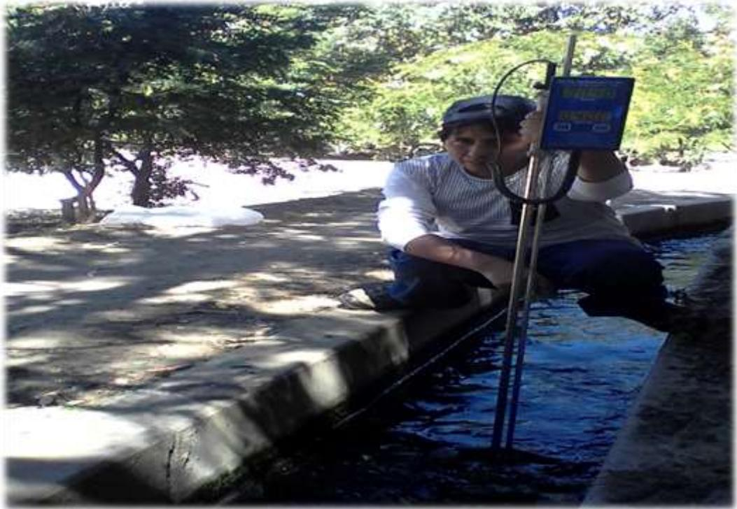
Figura 09: Medicion de la velocidad con el equipo de correntometro
