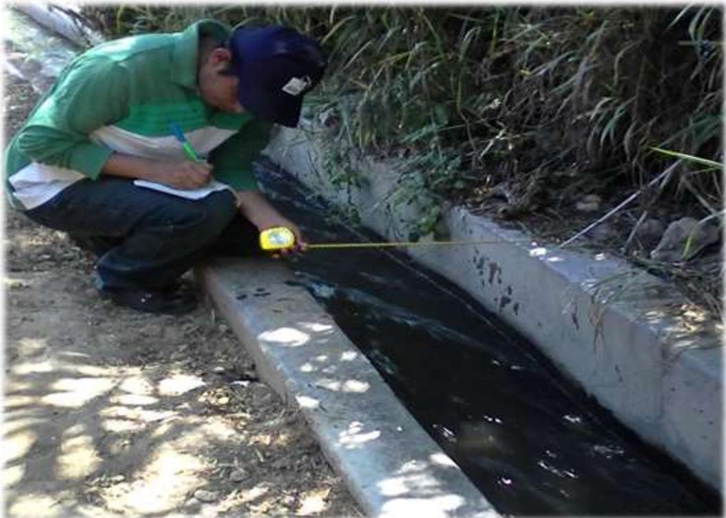
Figura 02: Medida del seccion del canal del canal abierto
