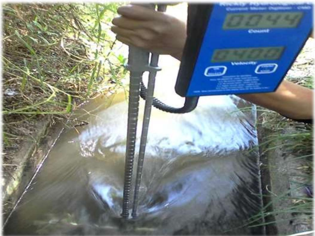
Figura 08: Medicion de la velocidad con el equipo de correntometro
