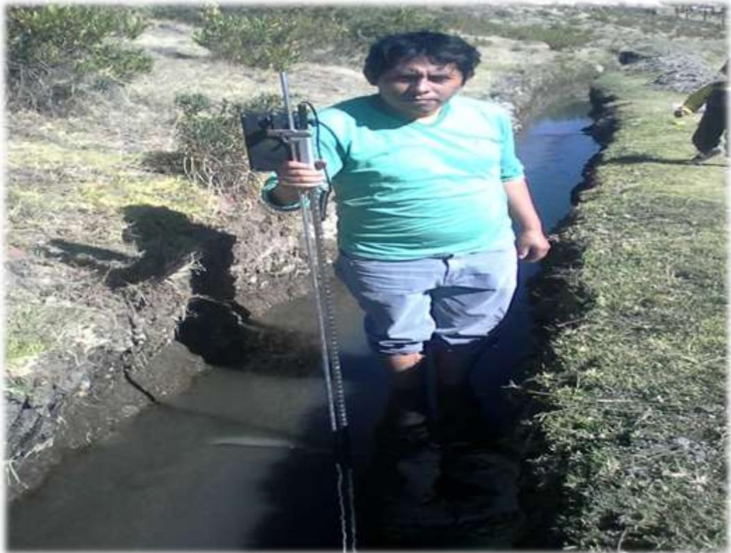
Figura 10: Medicion de la velocidad con el equipo de correntometro
