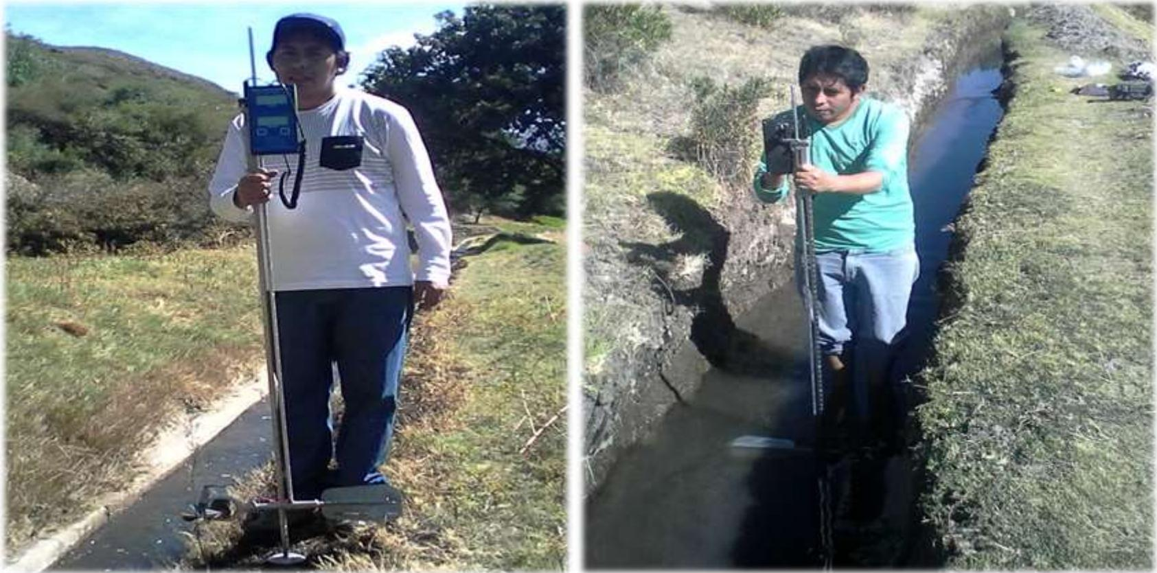
Figura 3.2: Medición de la velocidad con el método correntometro
