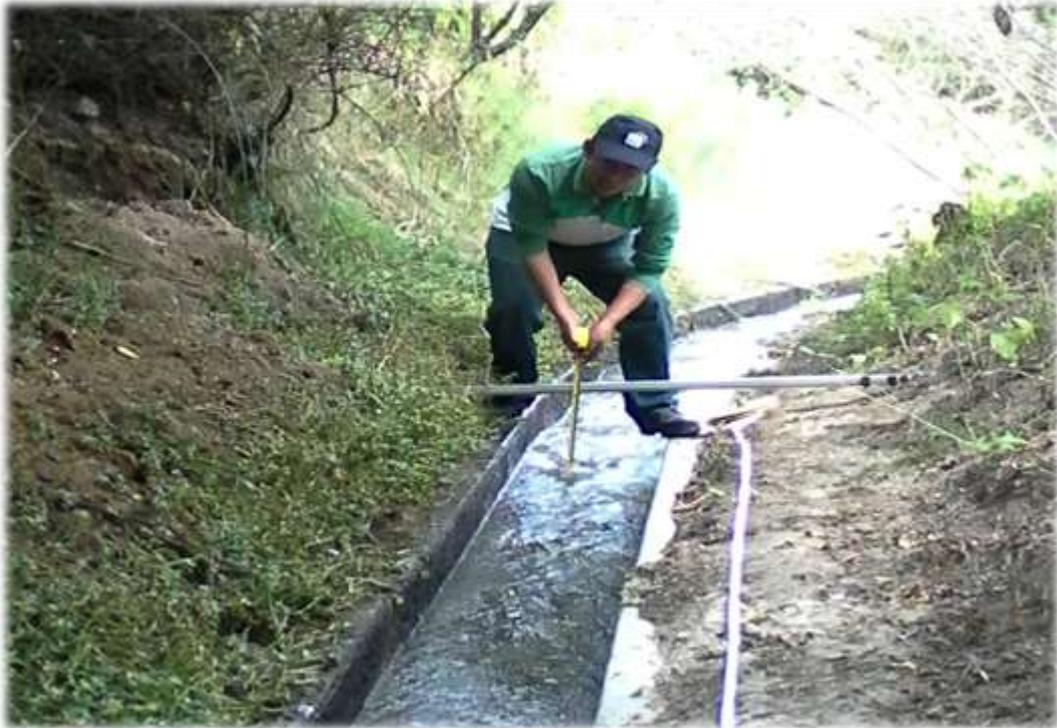
Figura 01: Medida del seccion del canal del canal abierto
