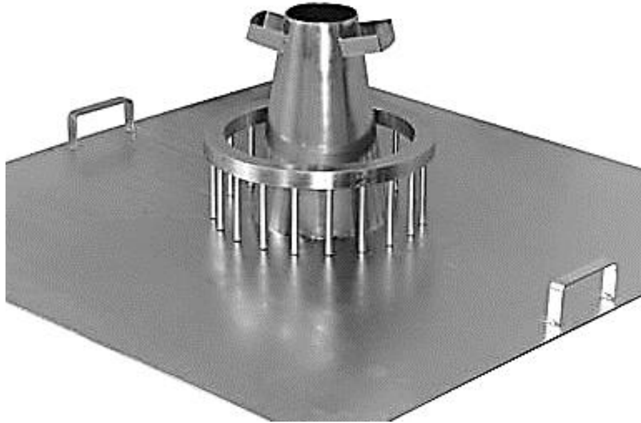
Figura 15: Representación del equipo de Anillo Japonés para evaluar la resistencia al bloqueo del CAC.
