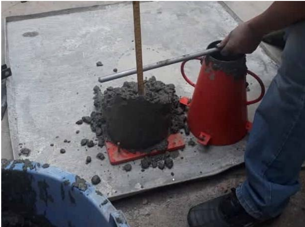
ANEXO 19: Ensayo de asentamiento (Slump).
