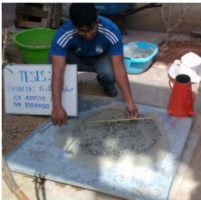
Figura 21: Segregación en la mezcla de concreto.
