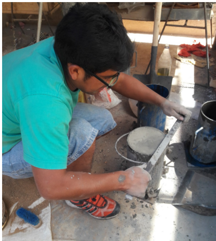
ANEXO 20: Elaboración de las testigos de concreto en las briquetas.
