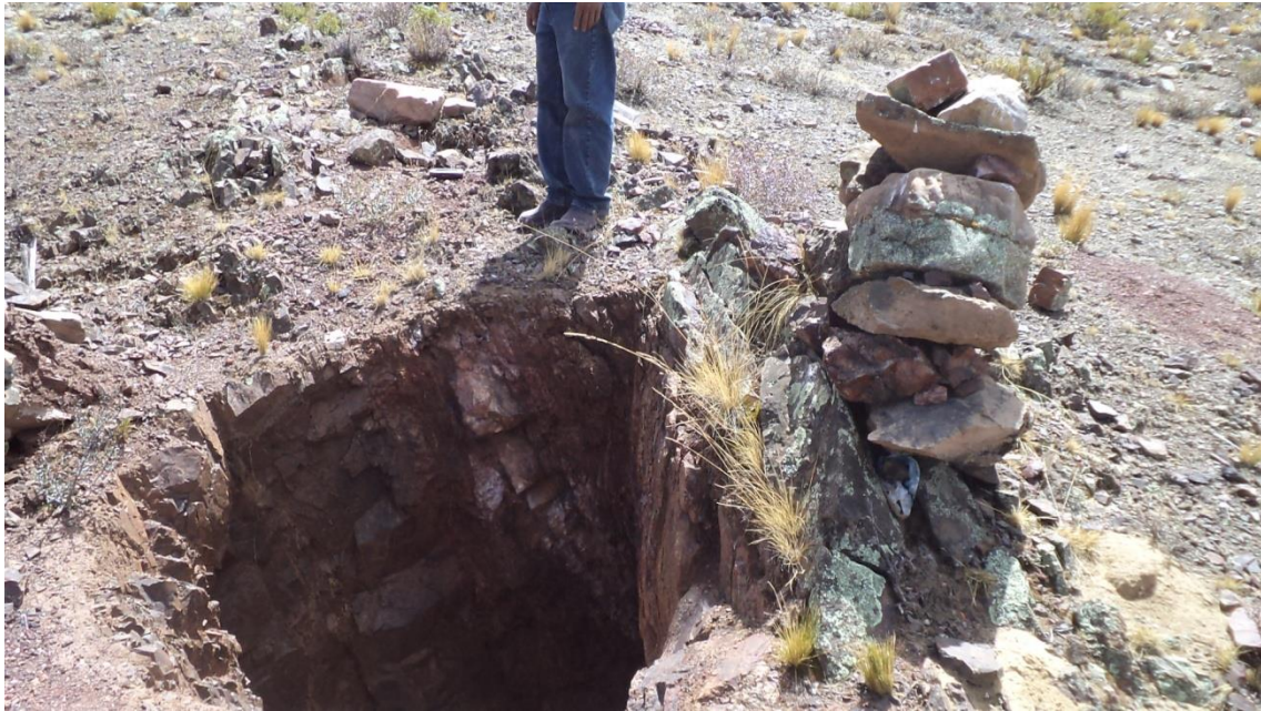
Foto N° 5 Pique de 15 mts de profundidad Veta 02 Maquiga
