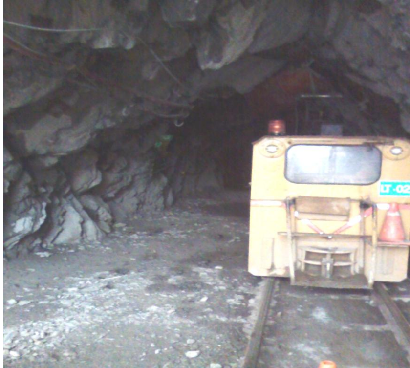
Foto N° 3: Locomotora de 6 ton a trolley en el XC-2006.
