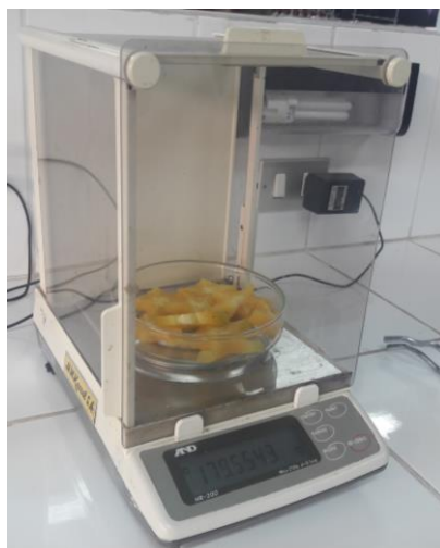
Figura 6: Determinación de humedad
