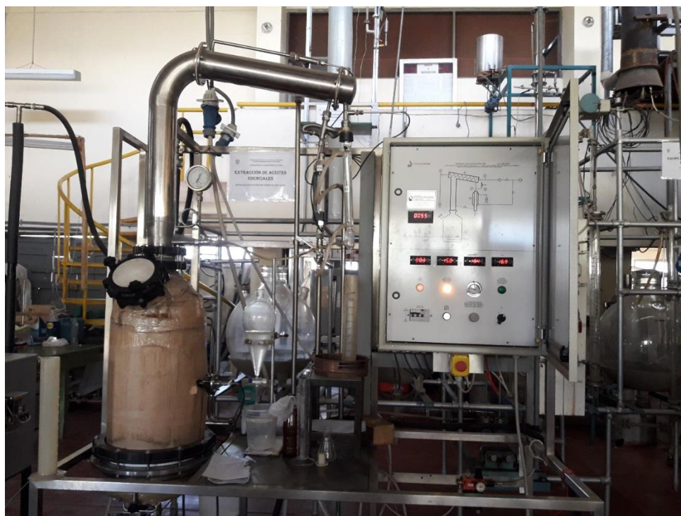
figura 24. Equipo modular de extracción de aceites esenciales
