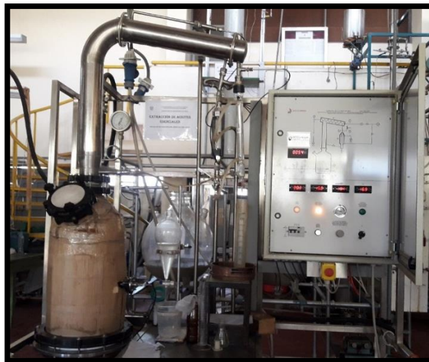
Figura 10. Módulo de extracción de aceites esenciales de laboratorio de Transferencia de masa de la Facultad de Ingeniería Química de la UNSCH empleado en la corrida experimental a escala planta piloto.
