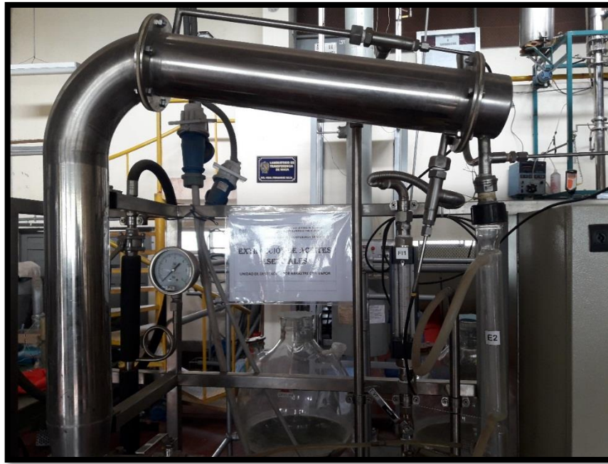
Figura 13. Ensamblado de condensador de tubos y coraza en el equipo modular de extracción de aceite esencial.
