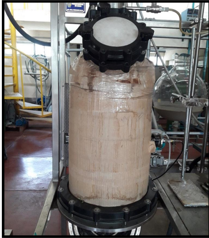
Figura 12. Recipiente de destilador del equipo de extracción de aceites esenciales
