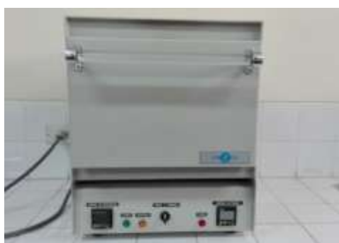
Muestra colocada en la mufla a 550°C por 7 horas
