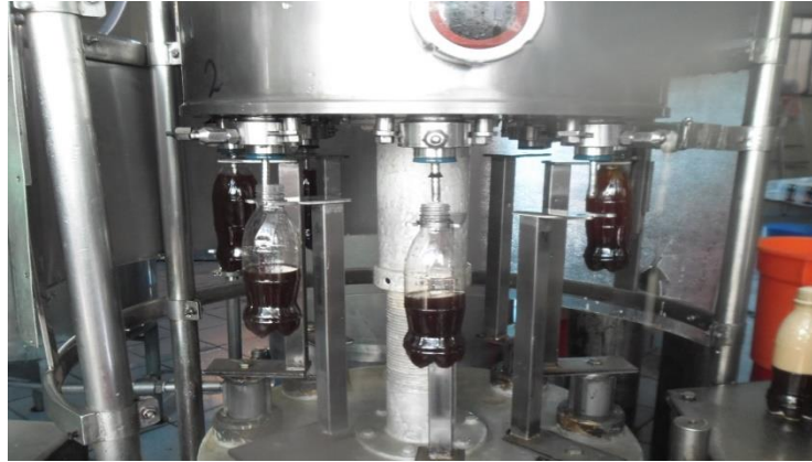
Imagen 13: Gasificado del jarabe.
