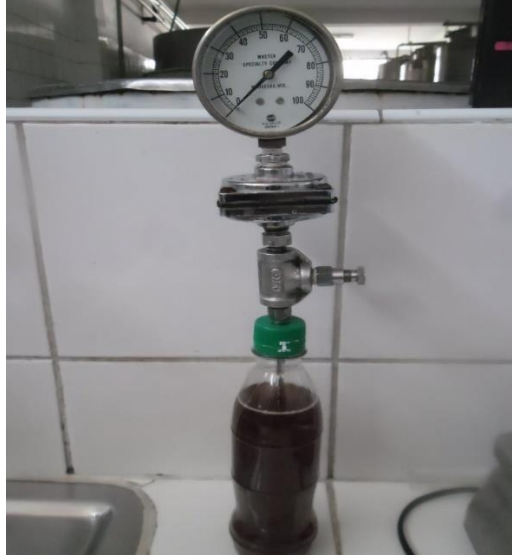
Imagen 16: Medición de nivel de CO 2
