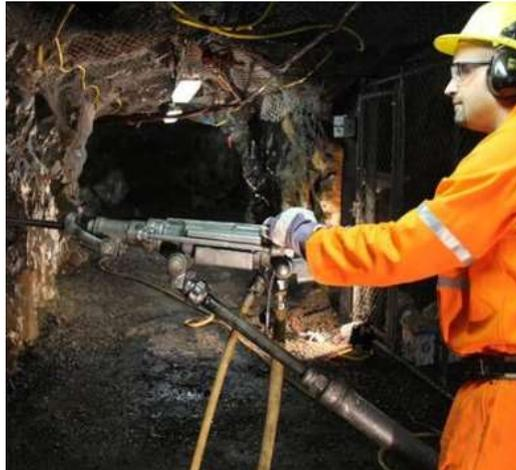
**Figura N° 1.8: Perforadora neumática de mano S250**
