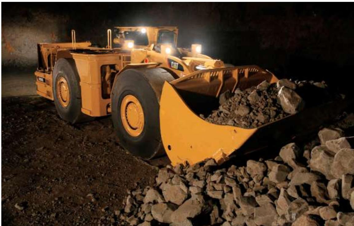
**Figura N° 1.4: Cargador de Bajo Perfil**
