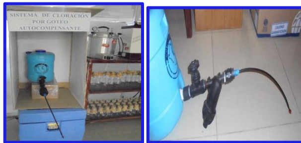
Figura 2.19 Modelo de cloración por goteo de la Dirección Regional de Salud Ayacucho (DIRESA).
