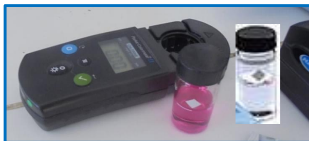
Figura 3.24 Reactivo DPD disuelto y el blanco
