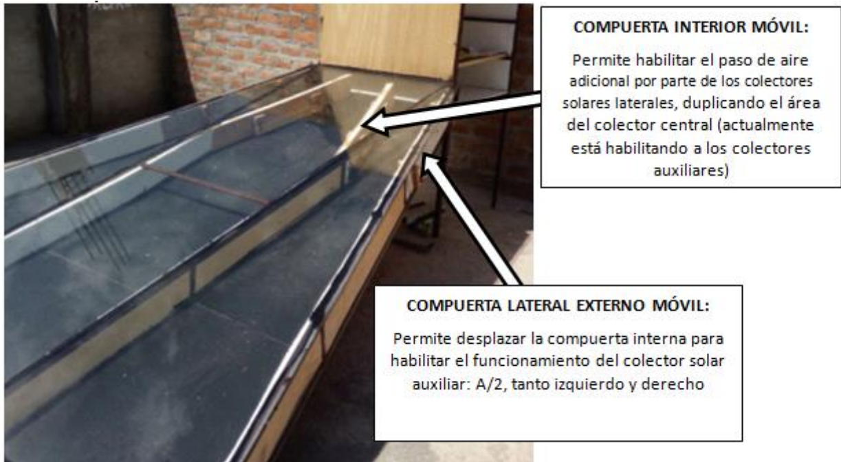
Figura 4.7 Aspecto mecánico de la compuerta móvil que permite la conmutación del aire caliente en función al área del colector solar plano de CS1 a CS2.
