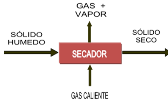
Figura 2.14 Esquema básico de un secador directo que usa aire caliente como agente de secado.
