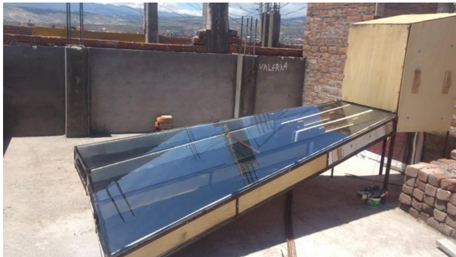
Figura 4.9 Vista fotográfica lateral del secador solar indirecto con cubierta de vidrio en el colector solar.
