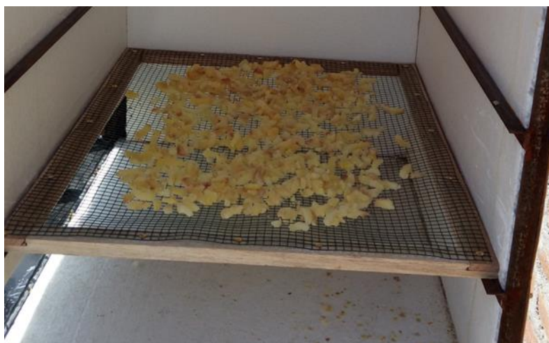
Figura 4.19 Ubicación de la bandeja tipo malla en el interior de la cámara de secado, portando los trozos de papa.
