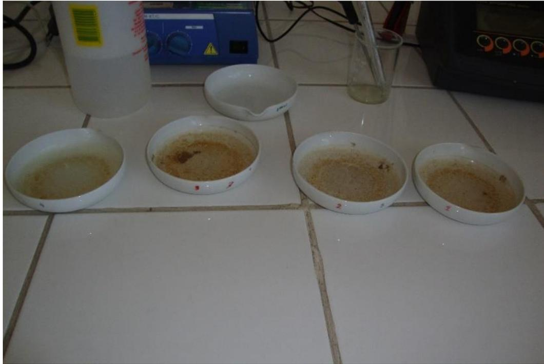
Figura 3.39: Determinación de sólidos suspendidos
