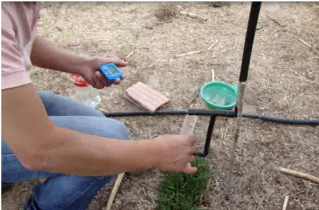
Figura 3.24: Punto de aforo de regulación de caudal de alimentación
