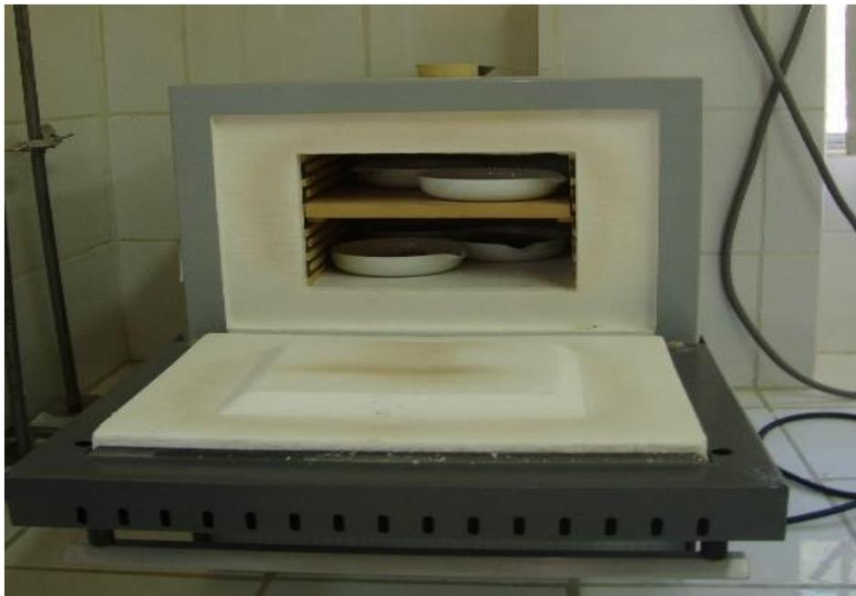
Figura 3.37: Determinación de sólidos volátiles totales
