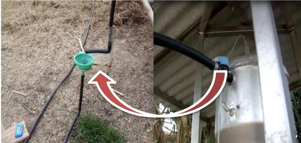
Figura 3.20: Punto de muestreo del efluente
