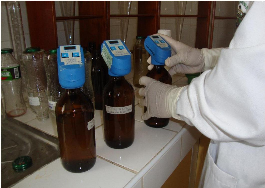
Figura 3.34: Determinación de demanda bioquímica de oxígeno
