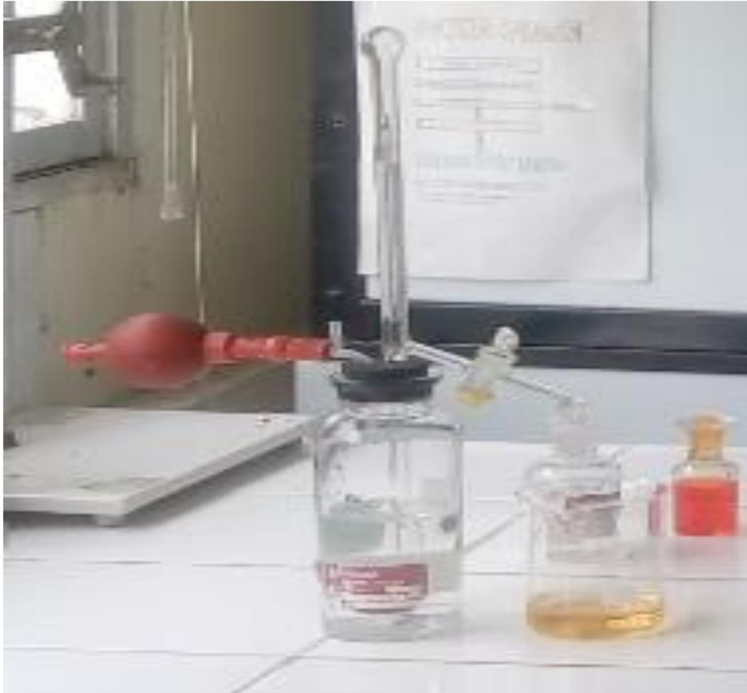
Figura 3.33: Determinación de alcalinidad
