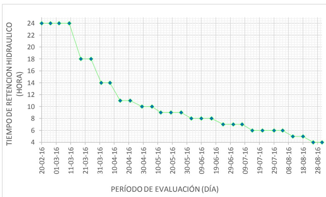
Figura 4.2: Comportamiento del tiempo de retención hidráulico (TRH)
