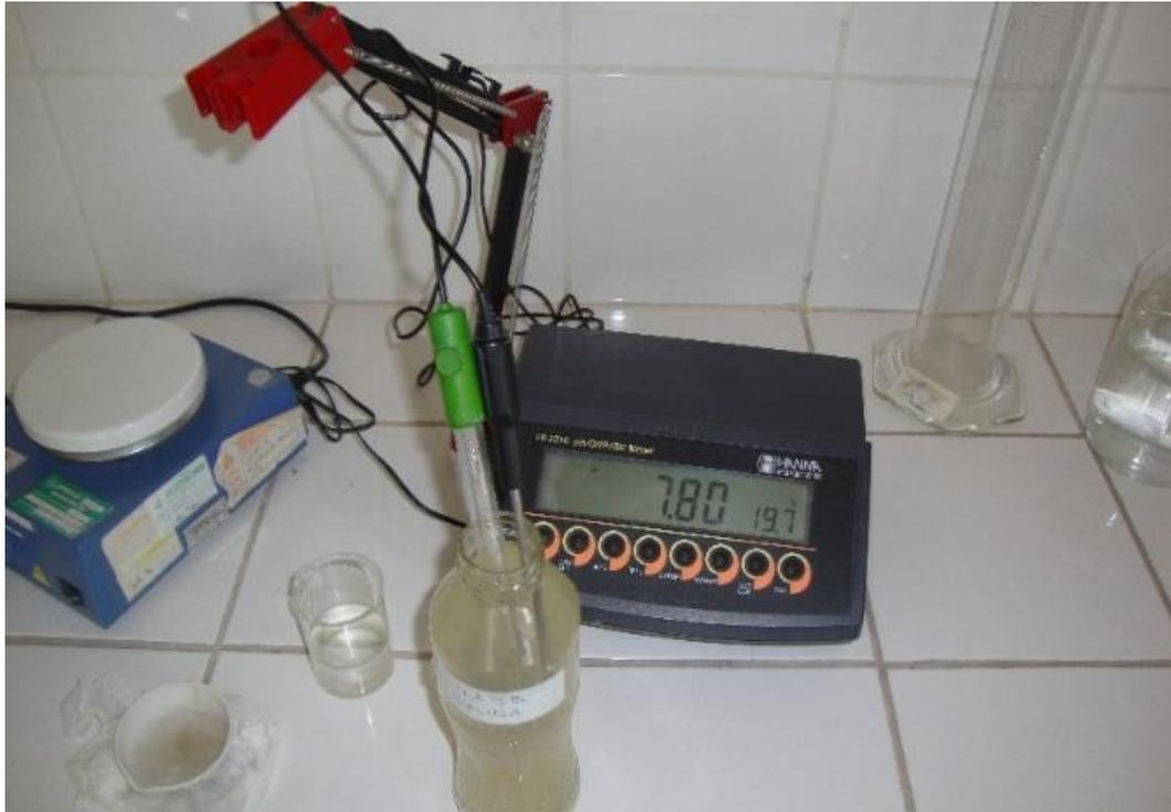
Figura 3.29: Determinación de pH
