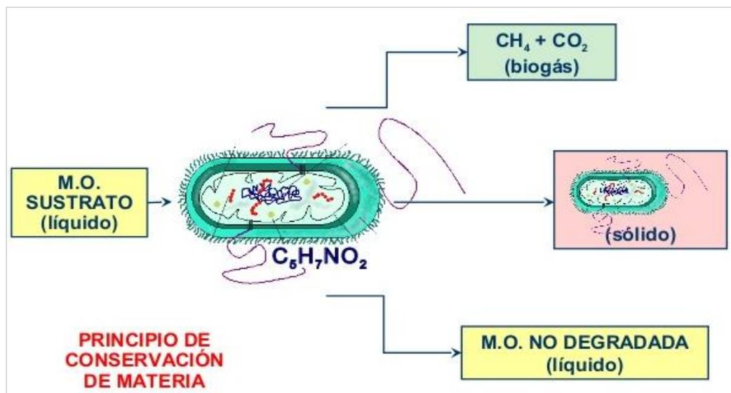
Figura 2.3: Bases de los procesos anaerobios (Polanco, 2014)
