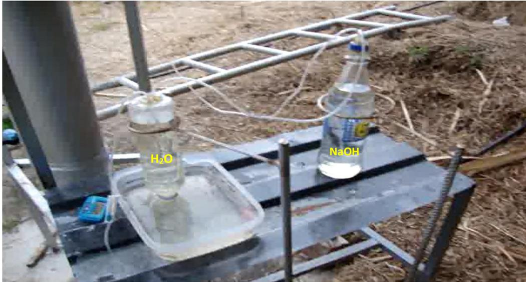
Figura 3.15: Instalación del sistema de recuperación del biogás
