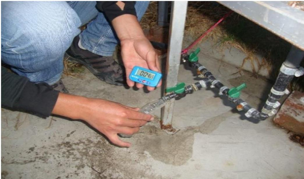
Figura 3.23: Válvulas de regulación de caudal y toma de muestras
