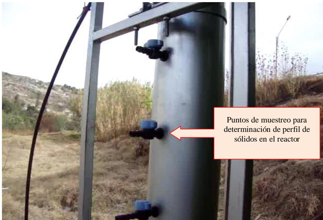
Figura 8: Puntos de muestreo del reactor
