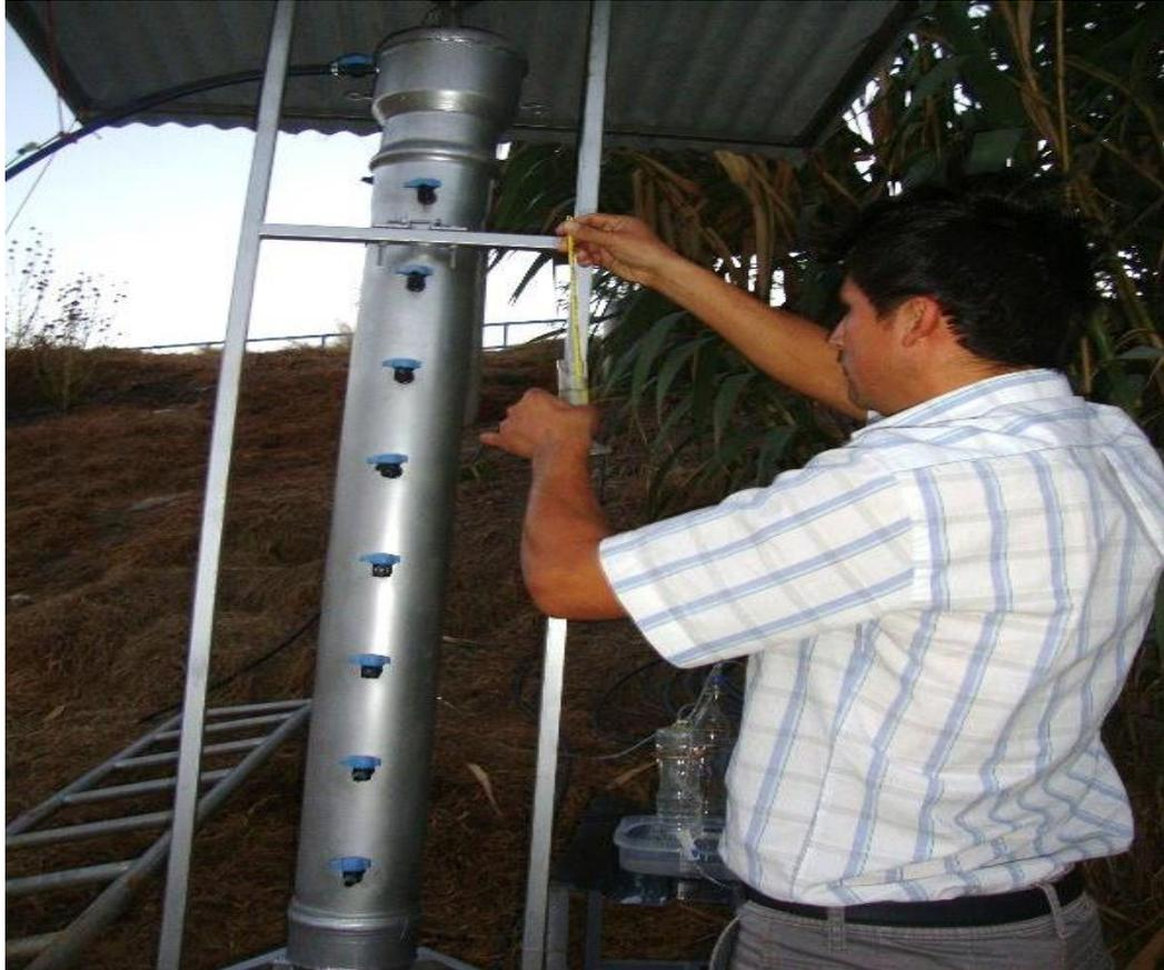
Figura 3.28: Determinación de temperatura.
