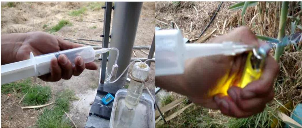
Figura 3.25: Extracción e incineración del biogás
