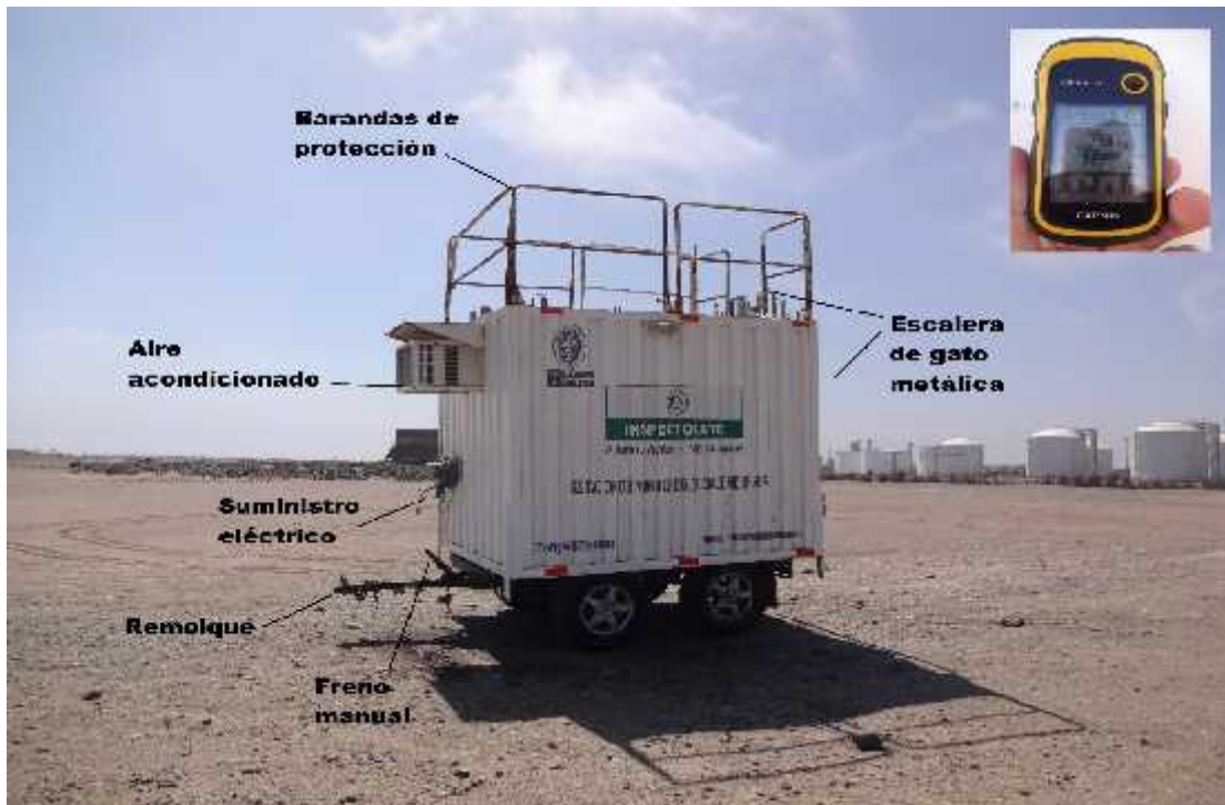
ANEXO N° 21: Ubicación del “SHELTER” en el lugar del monitoreo de calidad de aire con el uso del GPS.
