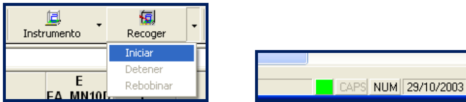
Figura 8.5 ventana para seleccionar el botón recoger y seleccionar iniciar y se activara el instrumento.
