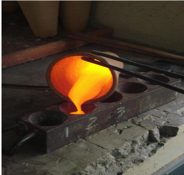
Figura 2.10 Fotografía de una carga fundente que cumple con las consideraciones básicas de la formación de escorias, obteniendo así una mezcla bastante fluida.
