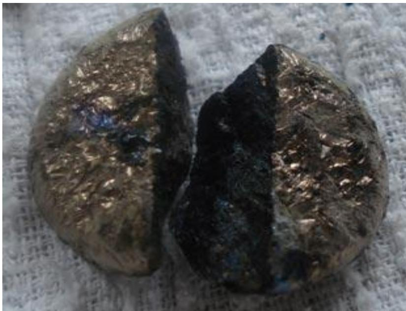
Figura 2.3: Fotografía de una fase mata generada en la fusión de un concentrado de sulfuros de cobre y hierro.
