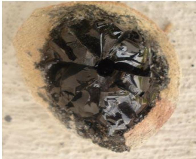
Figura 2.2: Fotografía de la fase escoria generada por fusión de una mezcla de óxidos de cobre y hierro, utilizando bórax como principal agente fundente.
