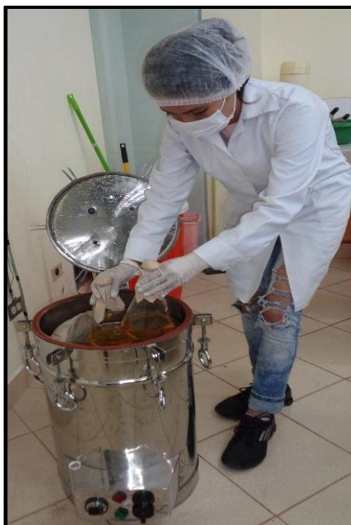
Foto 08: Colocando los medios a la autoclave a 121 ° C x 15 libras de presión a 15 minutos
