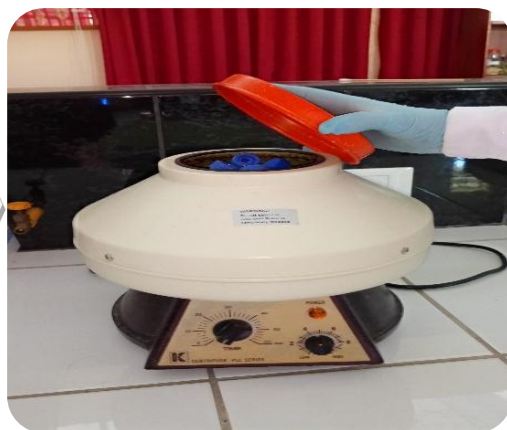
Llevado al centrifuga a 1000rpm/1min
