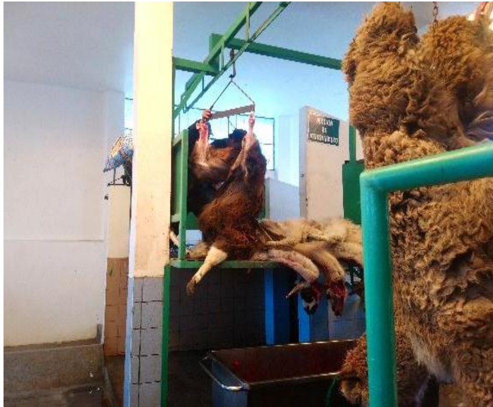
Foto 4. Elevación del canal al riel de matanza
