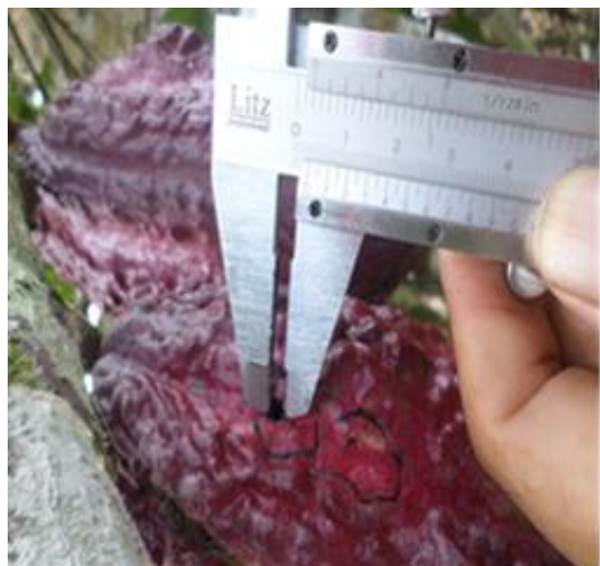
Foto 54: Medida del \phi de perforado.
