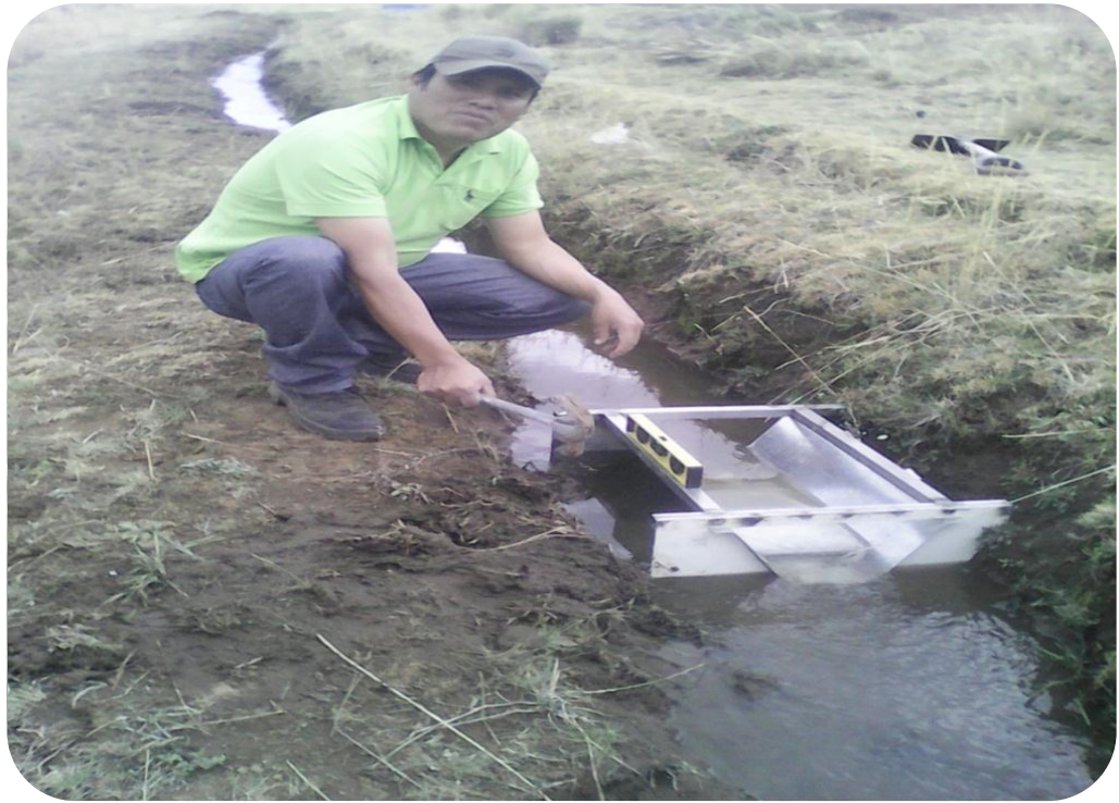
Vista 07: Aforamiento en la salida del reservorio, con aforador portátil RBC
