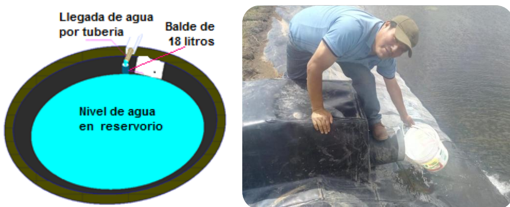
Figura 2.10: Aforo ingreso del reservorio (volumétrico balde de 18 litros)
