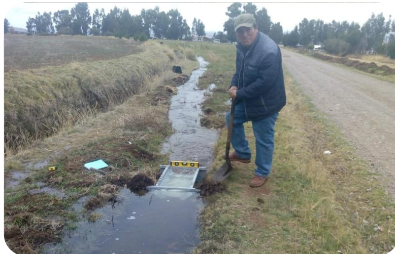
Figura 3.14: Aforador portátil RBC, medición del caudal de ingresa a la parcela
