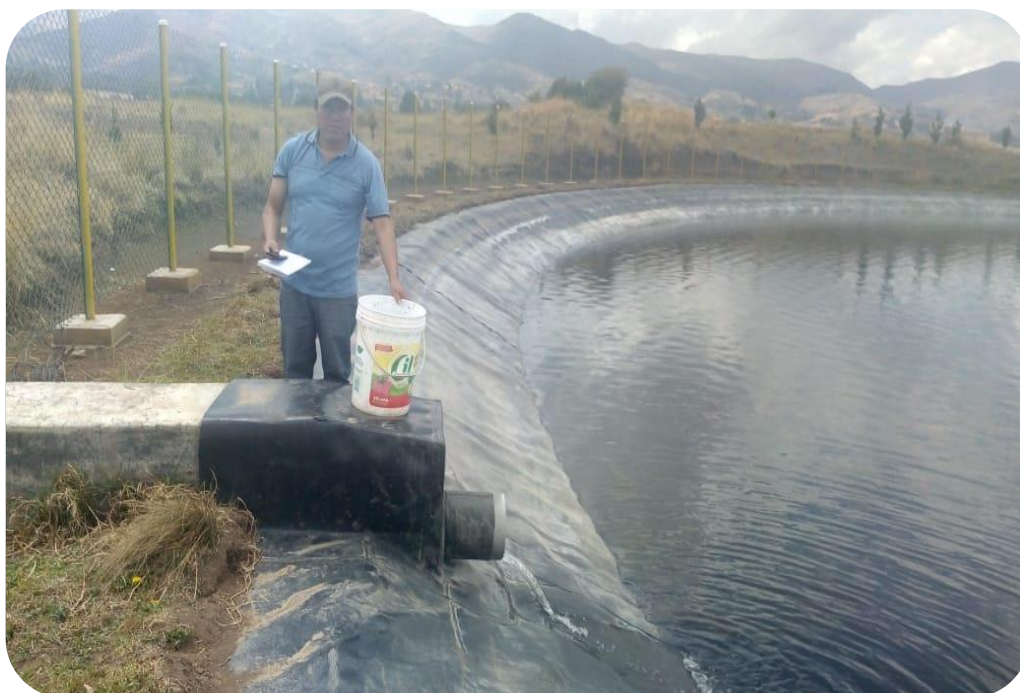
Vista 05: Aforamiento en el reservorio por el método volumétrico, con un balde
