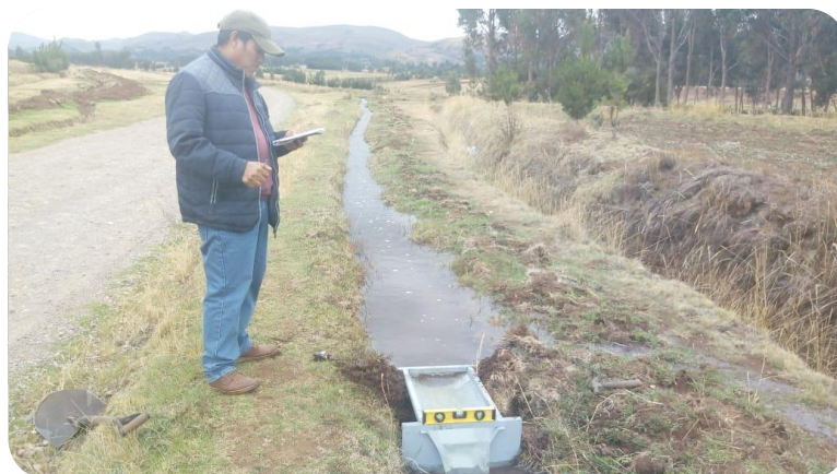
Figura 2.18: Volumen de ingreso a la parcela medido con aforador RBC
