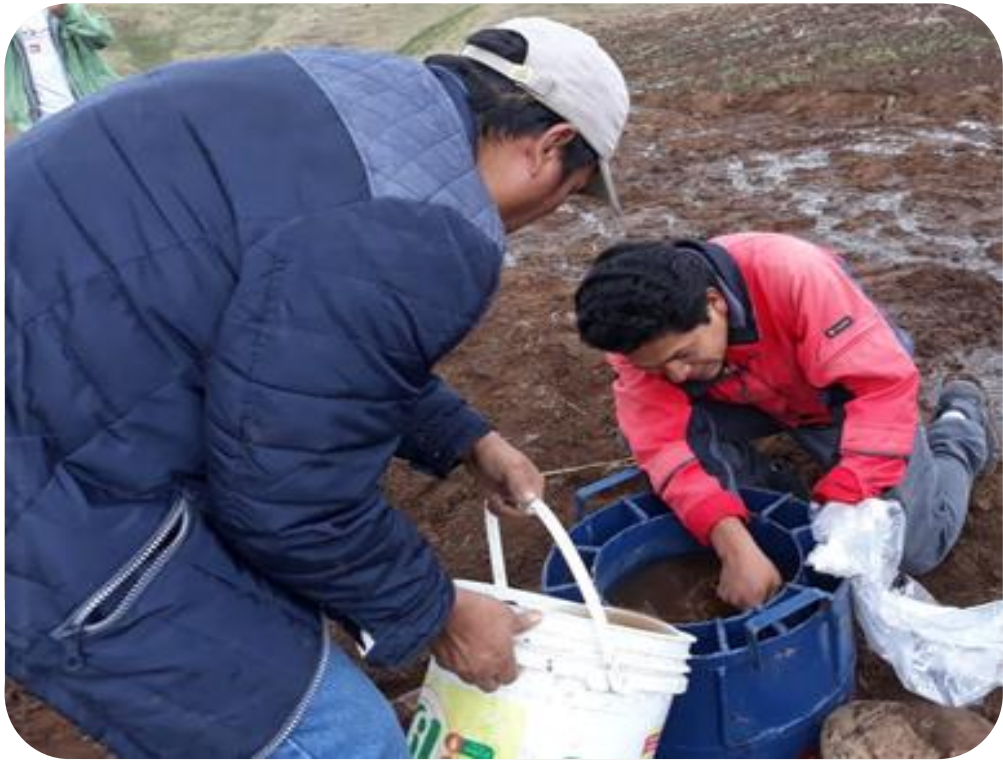
Vista 11: Realización de la prueba de infiltración en campo
